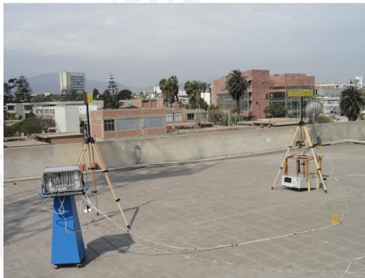
FIGURA 4-2: MÉTODO DE MEDICIÓN DE LOS PATRONES DE RADIACIÓN
