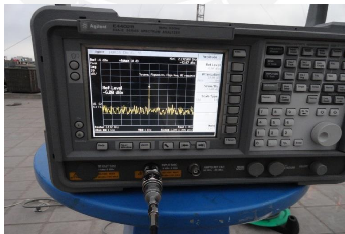
FIGURA 4-3: VISUALIZACIÓN DE LA SEÑAL A 2.1325 GHz RECIBIDA POR LA ANTENA DE REFERENCIA EN EL ANALIZADOR DE ESPECTRO
