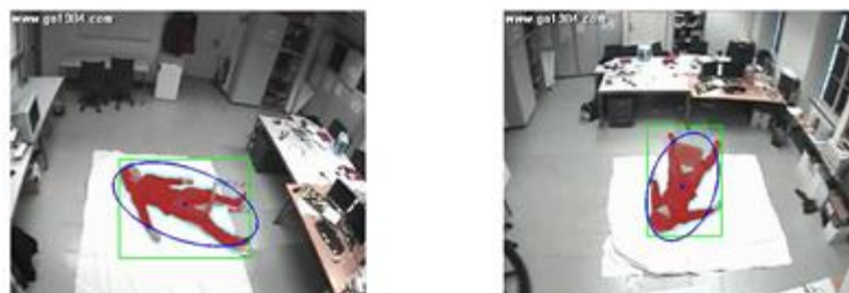
Figura 2.24 – El empleo de cámaras detecta la postura a través de la medición de los ejes de la elipse que envuelve a la persona caída. También es posible la medición de velocidad de movimientos mediante la variación de píxeles en un frame (Cogvis 2010)
