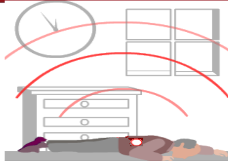
Figura 2.26 – Sensores de aceleración detectan el impacto de caída, se genera una alarma vía ondas de radio. Esta técnica se puede combinar con detección basada en entorno
