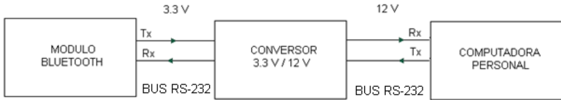
Figura 4.12 – Esquema de conexión para las pruebas de comunicación entre el módulo Bluetooth y una computadora personal mediante RS-232 (Fuente: Elaboración propia)
