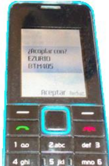
Figura 4.16 – Teléfono celular Nokia 3500c respondiendo al pedido de acoplamiento solicitado desde la computadora personal mediante comandos AT (Fuente: Elaboración propia)
