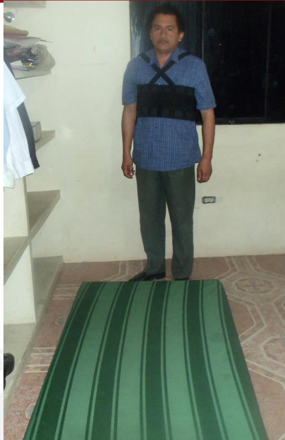
Figura 4.37 – Voluntario adulto para algunas de las pruebas en escenarios controlados de caídas. La faja en el pecho contiene el sensor y circuito electrónico para detección de caídas (Fuente: Elaboración propia)
