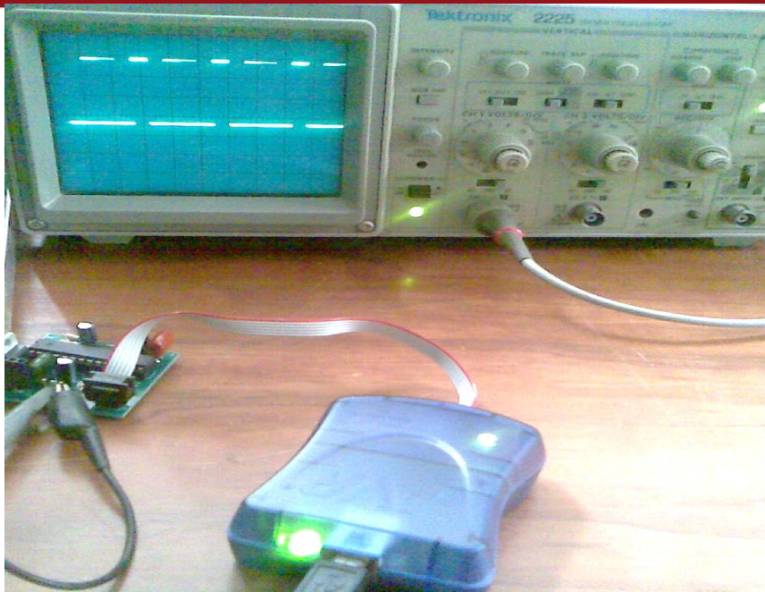
Figura 4.3 – Datos de aceleración enviados por el microcontrolador, por el puerto RS-232, hacia la computadora personal. Se observa también el programador Atmel (Fuente: Elaboración propia)
