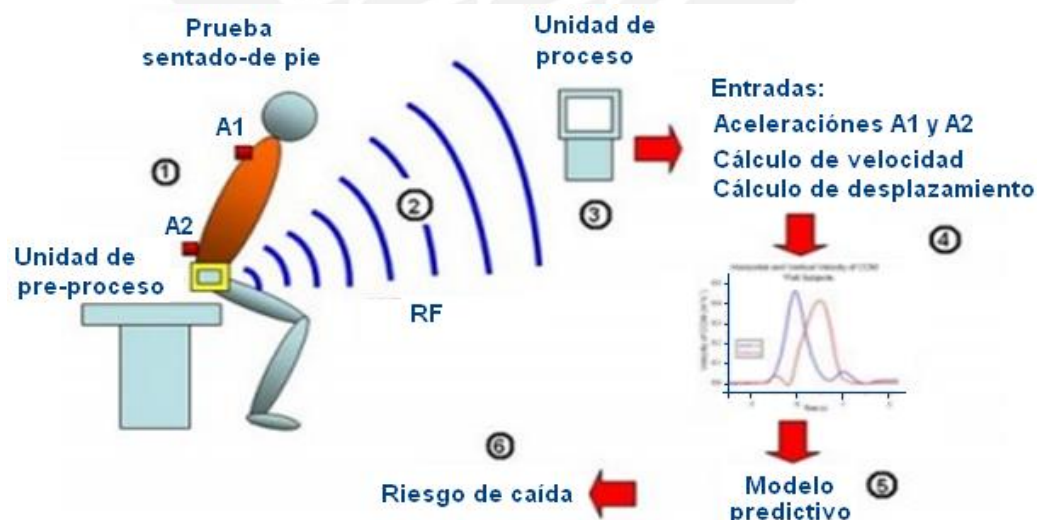
Figura 2.27 – Sistema inalámbrico de medición y predicción de la tendencia a caer de un adulto mayor (Fuente: Guzmán 2010)
