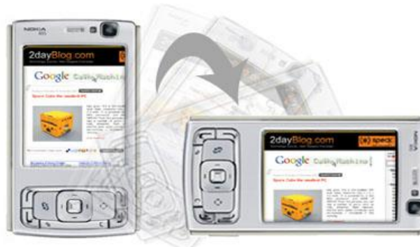
Figura 2.41 – Una aplicación de los acelerómetros en dispositivos móviles: orientación automática de la imagen al girar el dispositivo
