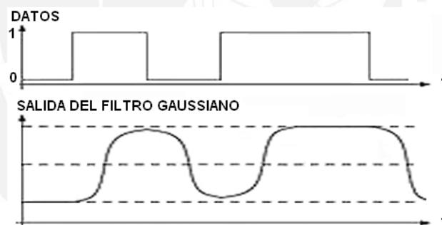
Figura 2.51 – Filtro gaussiano, aplicado a la banda base, para reducir el ancho de banda por eliminación de componentes de alta frecuencia de la señal digital
