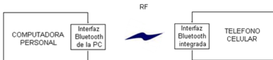
Figura 4.5 – Prueba de comunicación Bluetooth entre una computadora personal y un teléfono celular. El enlace emula un bus RS-232 y permite el envío de comandos AT al teléfono desde la computadora (Fuente: Elaboración propia)
