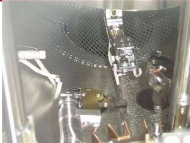
**Figura 7: Foto del interior de la cámara donde se muestra al manipulador con la muestra de Si, el evaporador de las moléculas y la mano mecánica.**
