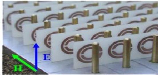
Figura 2.2: Primer Metamaterial diseñado por el equipo del Dr. Smith en UCSD
