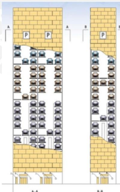
Imagen 5-6. Torre de Estacionamiento Paletizado Doble y Simple Fuente: <http://www.plus-park.com.ar/>
