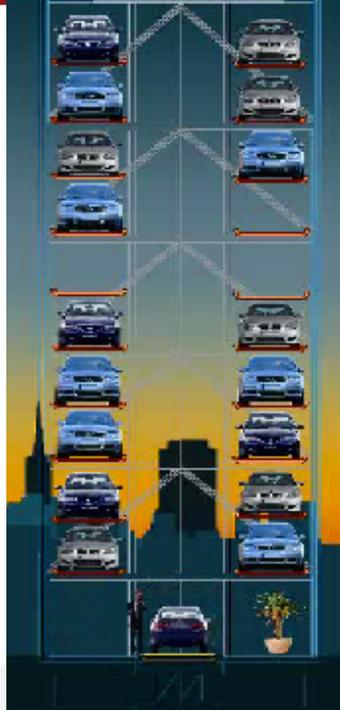
Imagen 5-5. Estacionamiento Paletizado Simple Fuente: <http://www.plus-park.ar>
