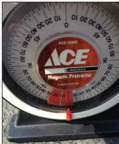
Figura 2.12 Medición de pendiente av. Raúl Ferrero - Cerro Centinela
