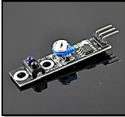
Fig. 3.2.1-3 Modulo sensor infrarrojo KY-033
