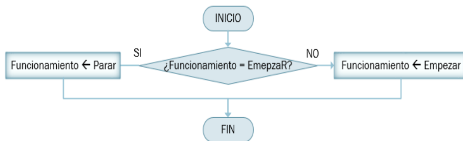
Fig.3.5-3 Diagrama de Flujo Interrupción Botón Pausa Continuar
