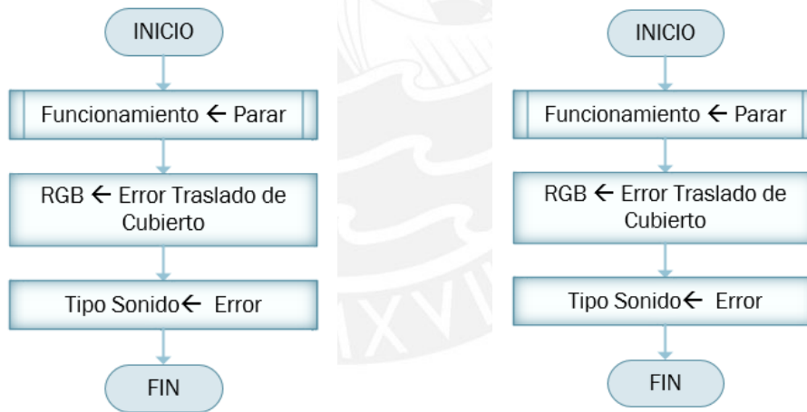
Fig. 3.5-8 Diagrama de Flujo Interrupción Control Anti falla Banda Frontal
