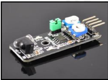
Fig. 3.2.1-1 Modulo sensor infrarrojo KY-032
