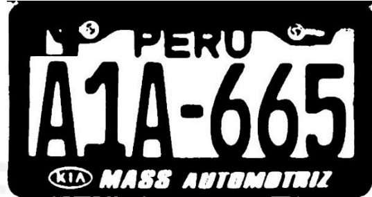
Imagen 5.1: Imagen de la placa aislada. Imagen 5.2: Imagen umbralizada usando el método de Otsu
