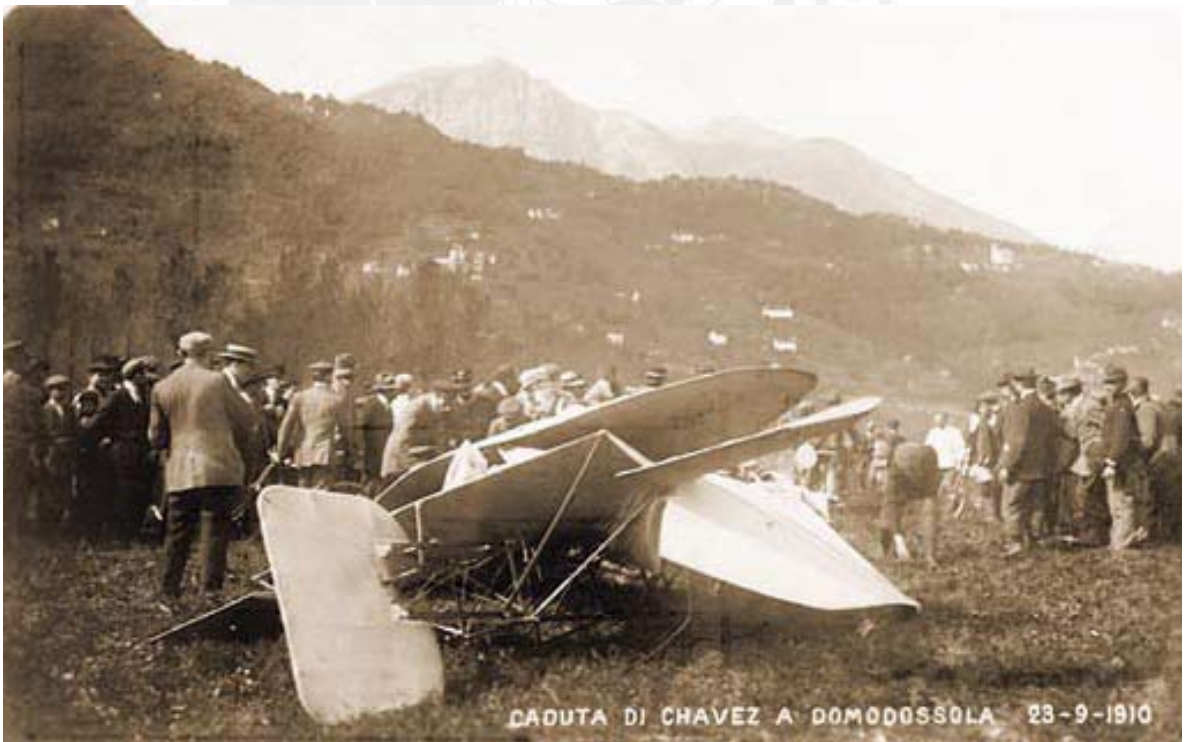
Posición final del Blériot XI donde se aprecia el conjunto de cola íntegro y las alas encima del fuselaje invertido. (Fuente: Il volo di Chavez , Edgardo Ferrari).
