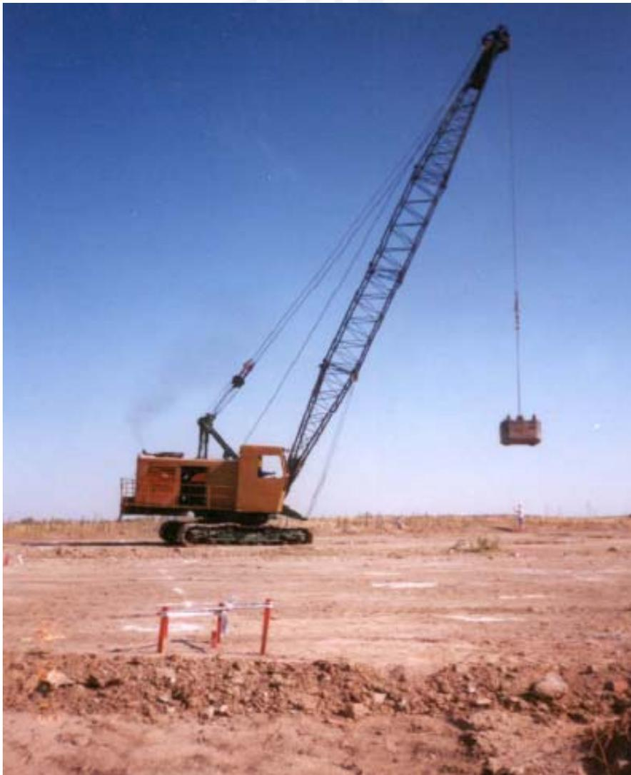
**Figura 3** Equipo de compactación dinámica (Simic D. 2011)
