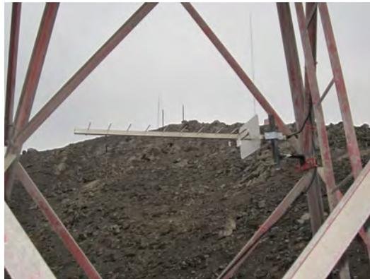
Figura 3.5: ANTENA YAGI PARA FRECUENCIAS DE UHF
