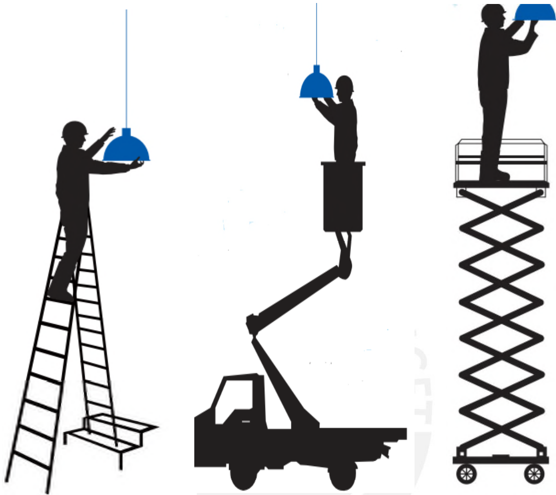
Figura 1.2: Procedimientos tradicionales para acceder a las luminarias. Fuente: Reel Tech.
