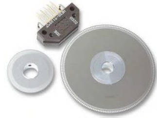
Figura 3.10: Encoder del sistema mecatrónico. Fuente: Avago Technologies
