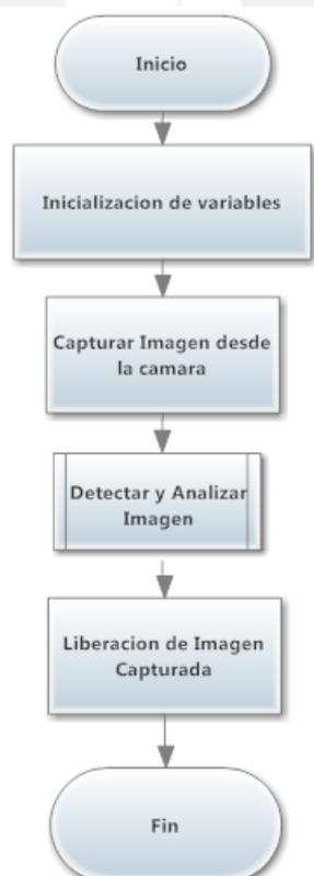
Figura 22 Diagrama de flujo: Aplicación para Tablet -Función Detectar Rostro
