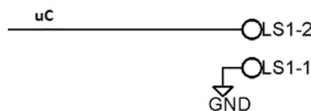
Fig. 3-48: Conexión de sensor de final de carrera
