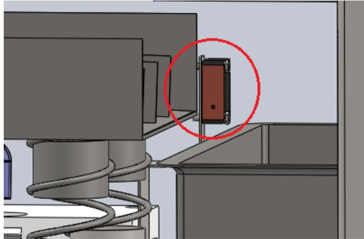
Fig. 3-3: Ubicación del sensor fotoeléctrico
