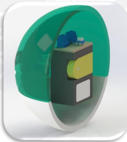
Figura. 3.2.2 – 2: Vista seccionada de la pelota. Fuente: Elaboración propia.
