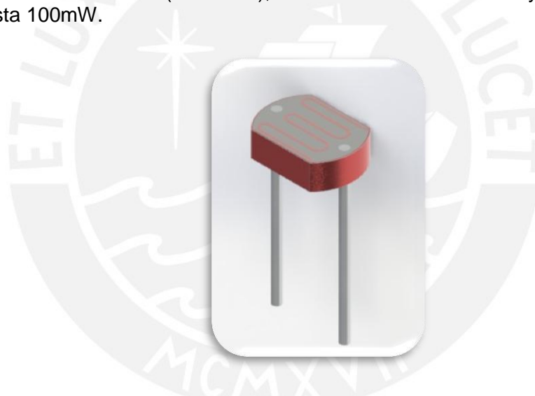
Figura. 3.2.1 – 1: LDR o Resistencia Dependiente de Luz. Fuente: Sunrom Technologies.
