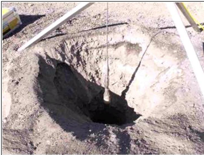
Figura 41. Introducción de la Sonda de Rayos Gamma en un taladro
