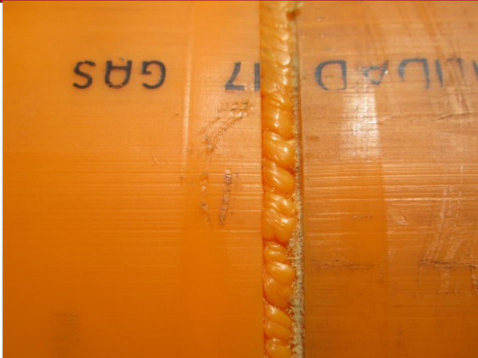
Figura 5. Apariencia externa soldadura a 600 RPM
