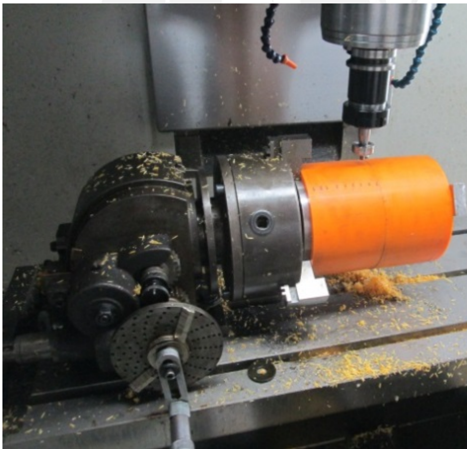
Figura 4. FSW de tuberías
