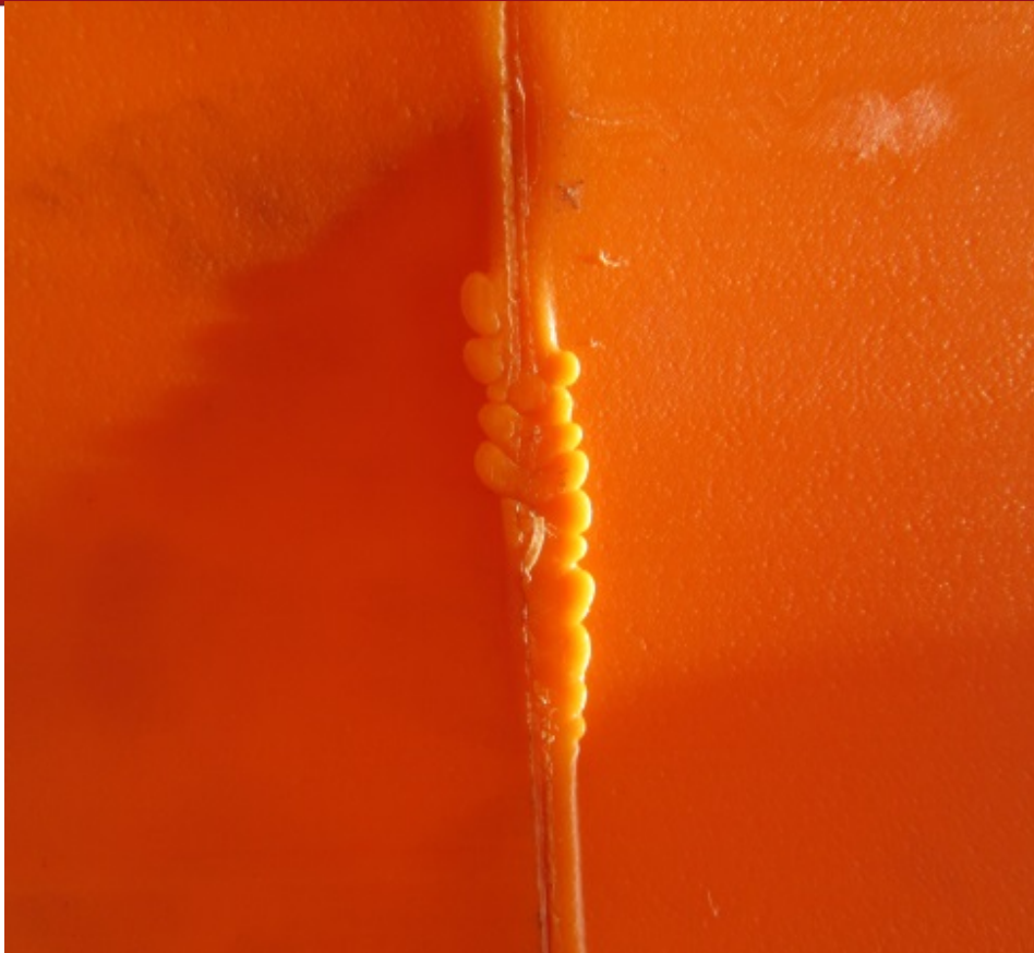
Figura 9. Defecto en la raíz de la soldadura a 3000 RPM
