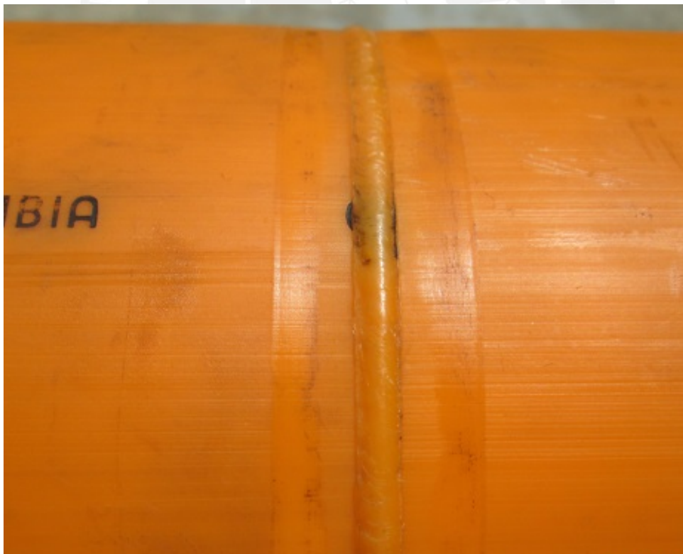
Figura 6. Apariencia externa soldadura a 1000 RPM
