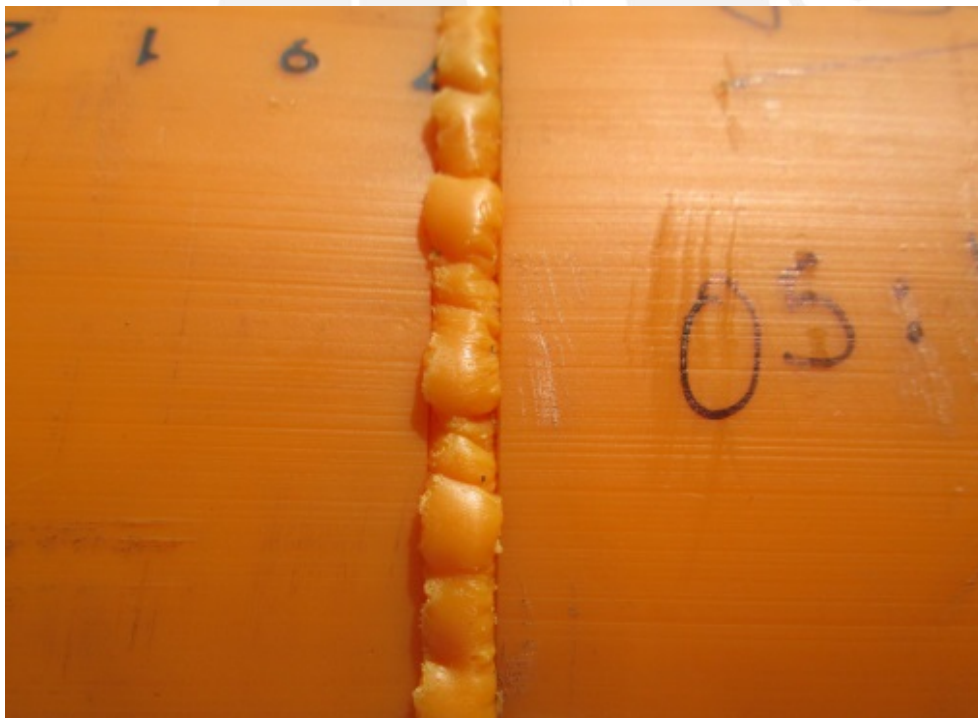
Figura 8. Apariencia de la soldadura a 3000 RPM
