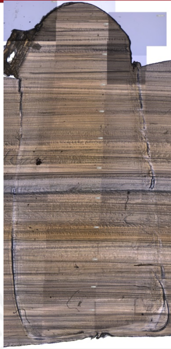
Figura 19. Microestructura de la soldadura a 2000 RPM
