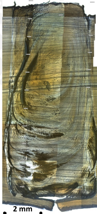
Figura 18. Microestructura de la soldadura a 600 RPM
