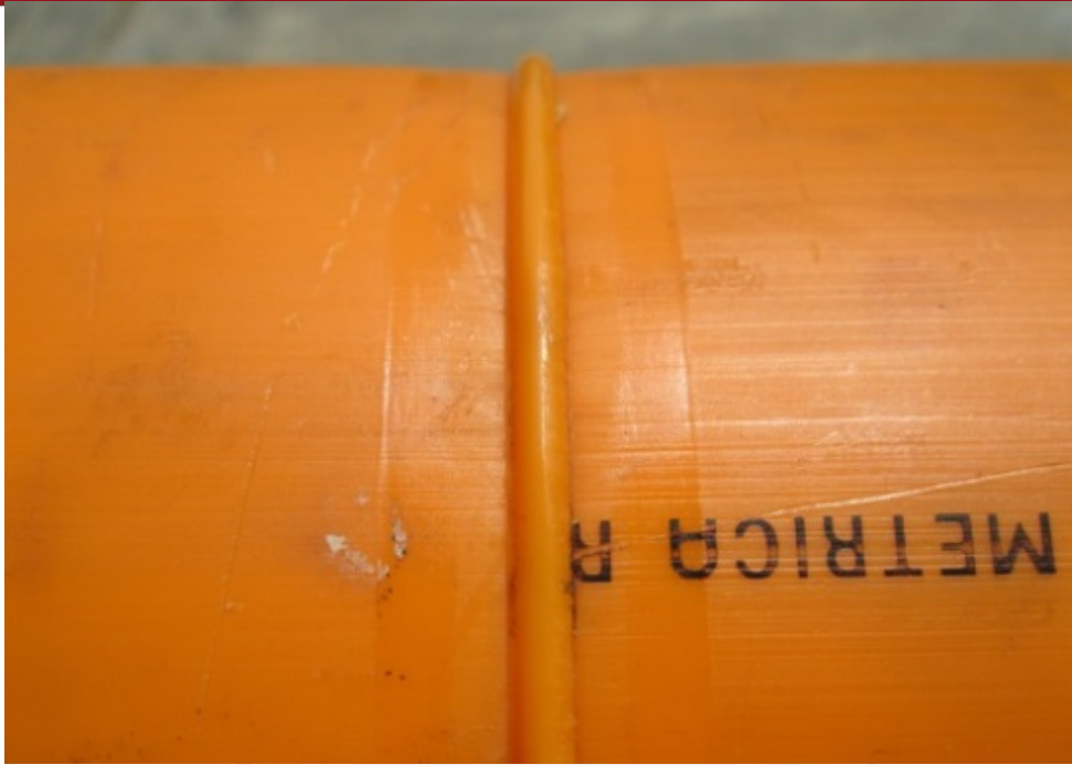
Figura 7. Apariencia externa soldadura a 2000 RPM
