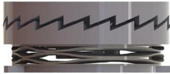
Figura 8: Detalle de la ubicación de los resortes en el mecanismo de la ratchet
