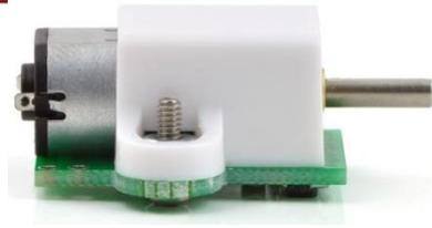
Figura 10: Tarjeta de encoder montada en soporte junto con motor
