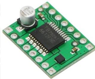
Figura 11: Detalle de tarjeta de controlador de motores
