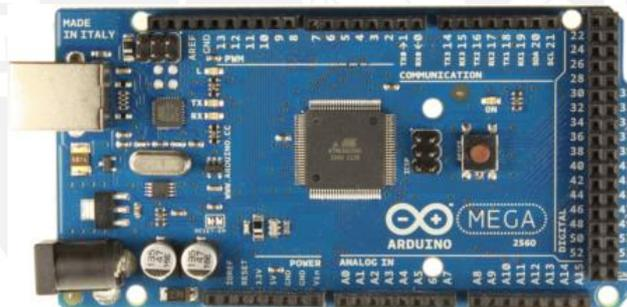
Figura 15: Detalle de tarjeta de Arduino Mega 2560 R3
