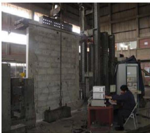
Fig. 6.10a.- Calibración de Muro e Instrumentación al Inicio del Ensayo
