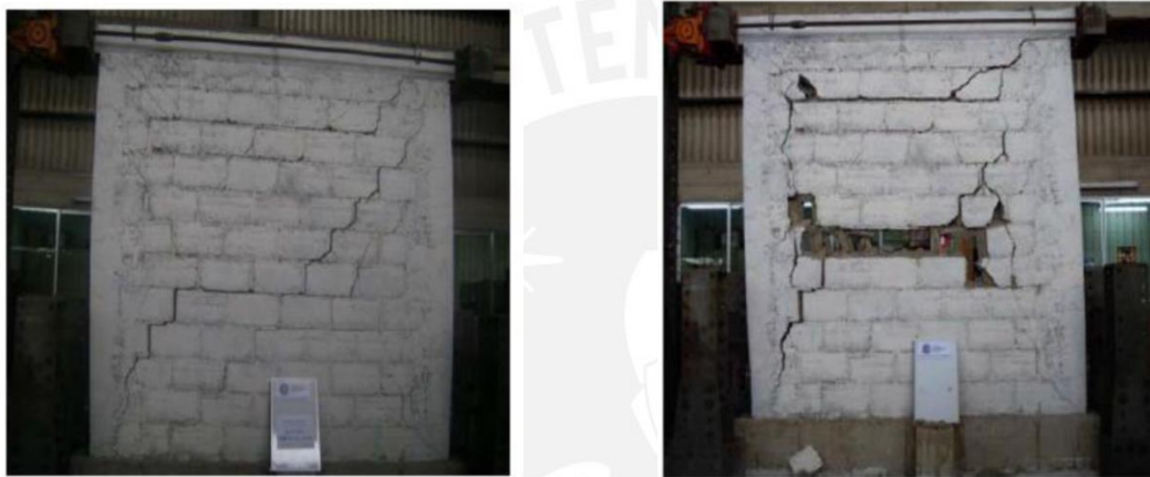
Fig. 6.8c.- Muro en la Fase Previa y Final del Ensayo
