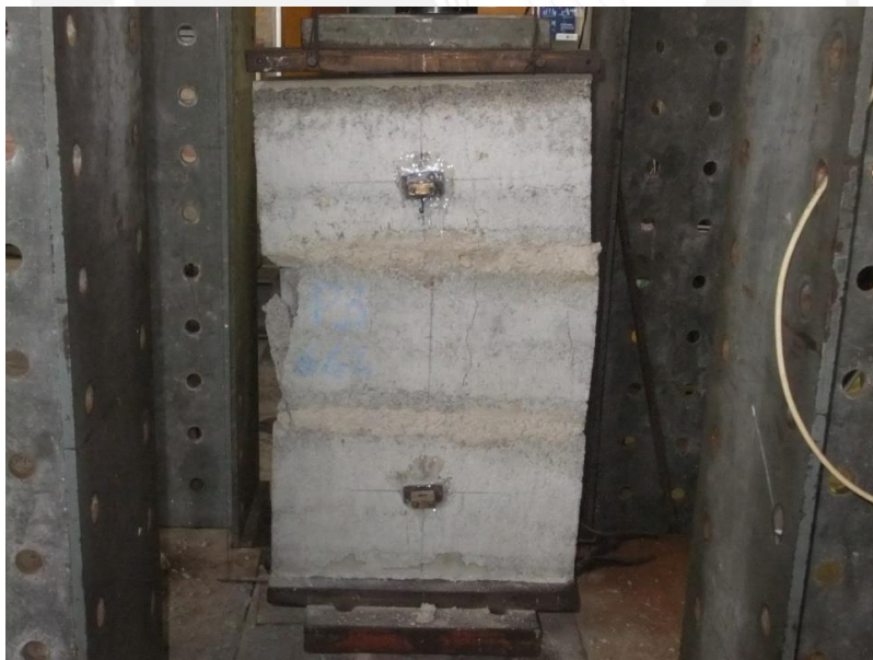
Fig. 3.6.- Tipo de Falla de Pilas
