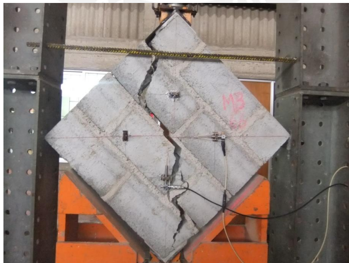
Fig. 3.7.- Tipo de Falla de Murete
