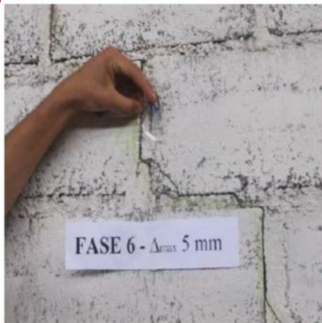
Fig. 6.9b.- Medición de Fisuras en las Fases 6 y 10
