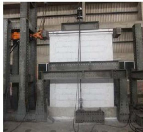
Fig. 6.10a.- Calibración de Muro e Instrumentación al Inicio del Ensayo
