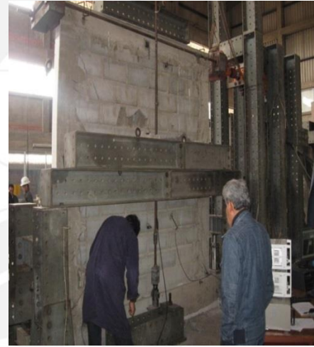
Fig. 6.4.- Instrumentación y Colocación de LVDT en Muro
