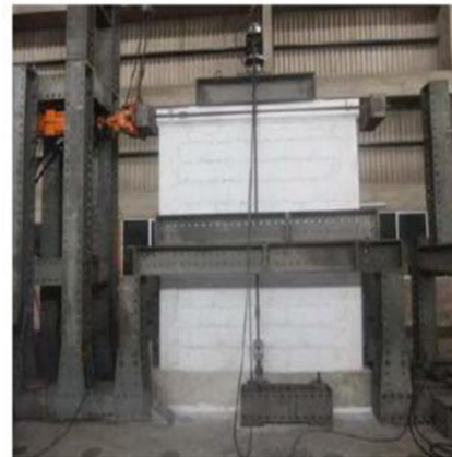
Fig. 6.5.- Calibración de equipos y Muro al Inicio del Ensayo
