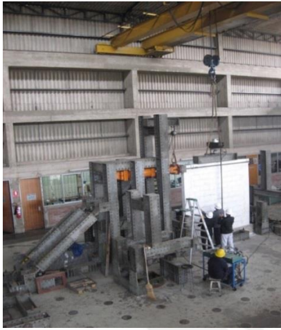
Fig. 6.4.- Instrumentación y Colocación de LVDT en Muro
