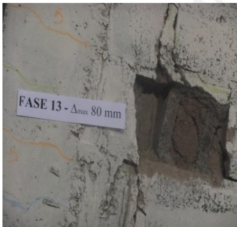
Fig. 6.9c.- Daños de Muro en la Fase 13 y Fase Final del Ensayo Muro 3-66%-CV
