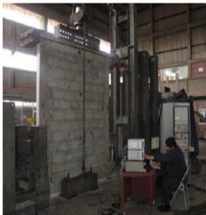
Fig. 6.5.- Calibración de equipos y Muro al Inicio del Ensayo
