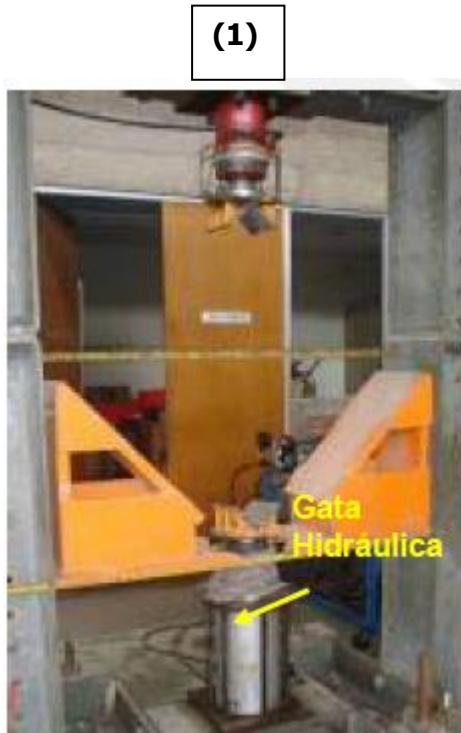
Fig. 3.10.- Instrumentación y Colocación de LVDT. (1) Tomado de la Tesis "Comportamiento Carga Lateral Cíclico Muro Confinado de Ladrillos de Concreto y Arcilla"-Paola Angles. (2) Tomado de Proyecto DGI 2012
