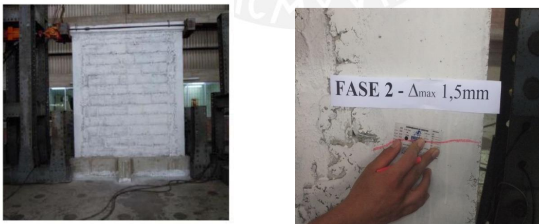
Fig. 6.9a.- Muro en la Fase Inicial del Ensayo y Medicion de Fisuras en Fase
