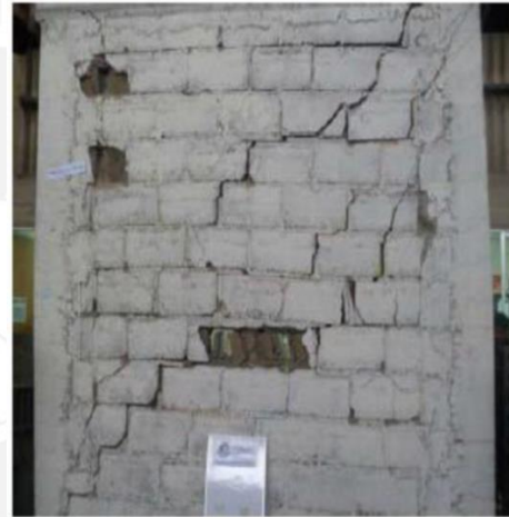
Fig. 6.9c.- Daños de Muro en la Fase 13 y Fase Final del Ensayo Muro 3-66%-CV
