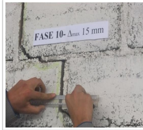
Fig. 6.9b.- Medición de Fisuras en las Fases 6 y 10
