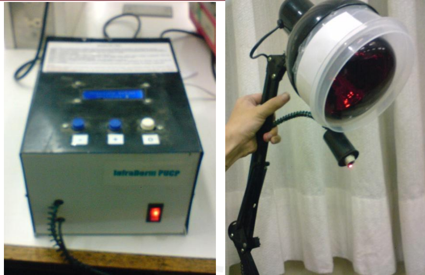
Figura 4.13. Chasis implementado del equipo. Izquierda: módulo de mando. Derecha: lámpara infrarroja y sensor de temperatura en un parante articulable.
