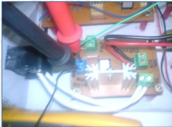
Figura 4.9. Pruebas de voltaje de entrada del excitador de potencia.
