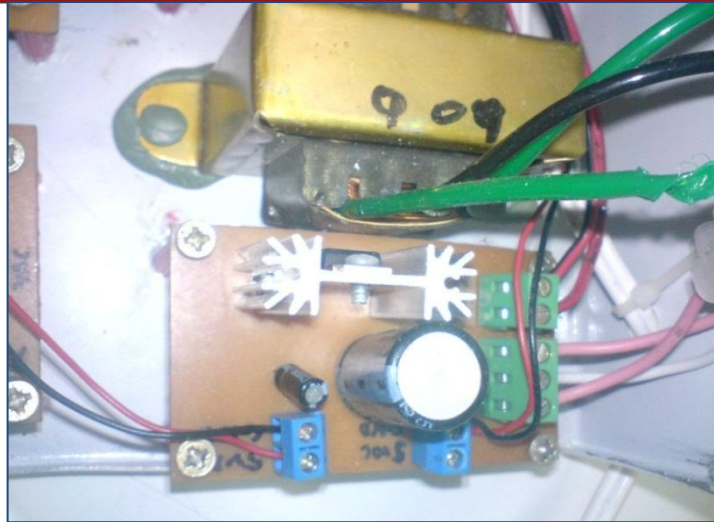
Figura 4.4. Tarjeta de alimentación DC con transformador de 220 V a 9-0-9 V
