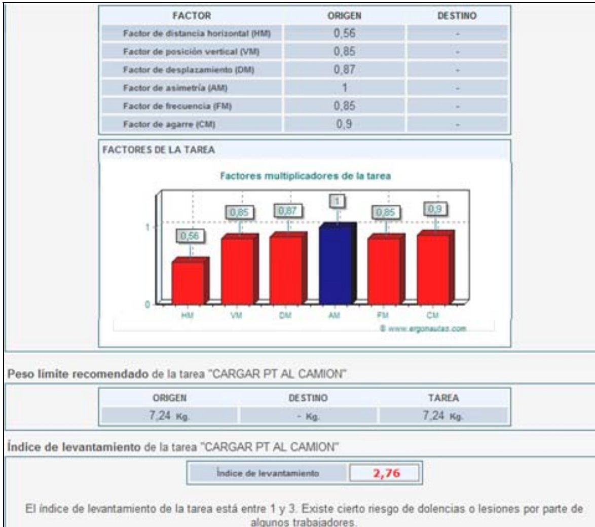
Figura 6. Resultado de cargar el producto terminado al camión. Fuente: Evaluación Propia utilizando Ergonautas-Toolbox2
