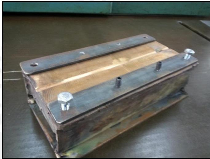
**Figura 2.10** Respaldo de cobre
