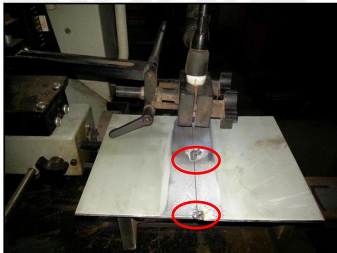
**Figura 3.1.** Dificultades en el apuntalamiento. Presencia de fisuración en caliente.
