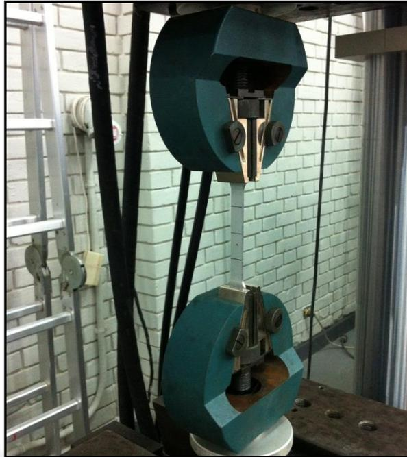
**Figura 2.22.** Probeta de material base puesta en máquina de tracción lista para ensayar.
