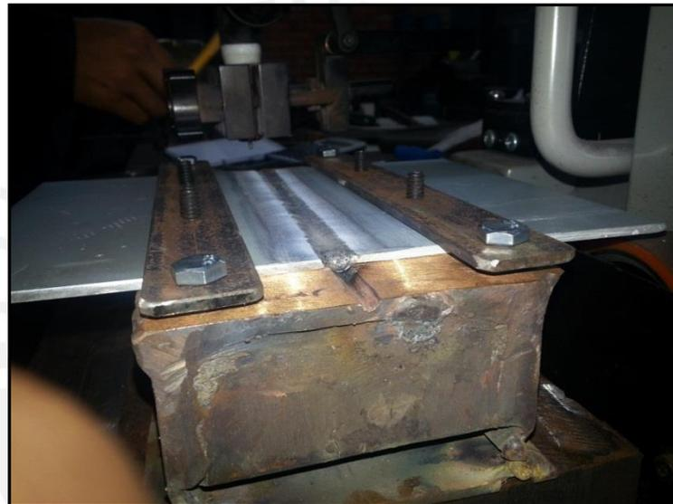
**Figura 3.2.** Posicionamiento de cupones para soldeo a tope.
