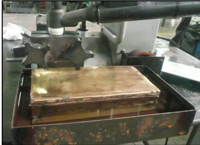
Figura 2.11 Respaldo de cobre refrigerado con agua de enfriamiento
