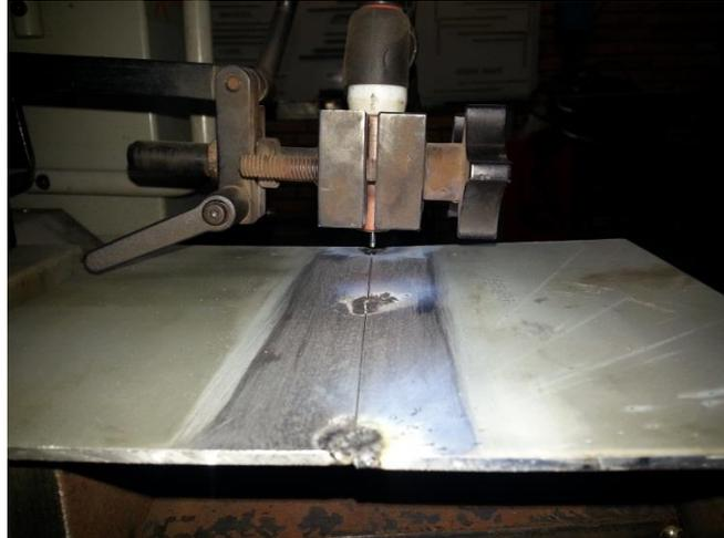
**Figura 2.7.** Soldeo a tope de planchas.
