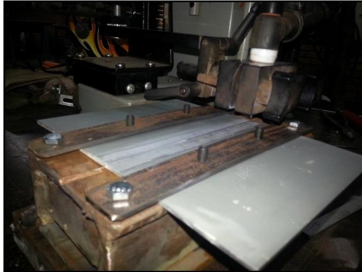
**Figura 2.15.** Sujeción a tope de planchas mediante platinas y pernos prisioneros
