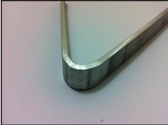
**Figura 3.12.** Doblado de cara en la probeta del cupón N°2.
