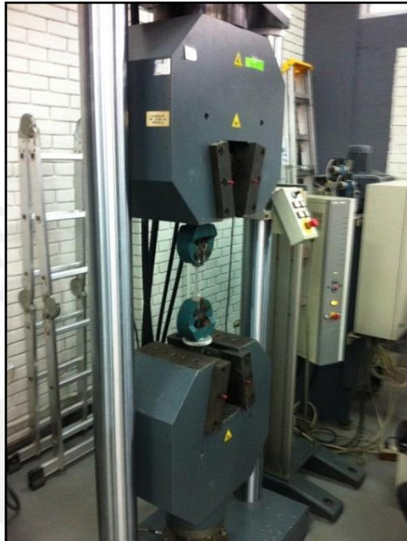
Figura 2.17. Máquina de tracción Zwick Roell Special Metal Testing Machina SP.
