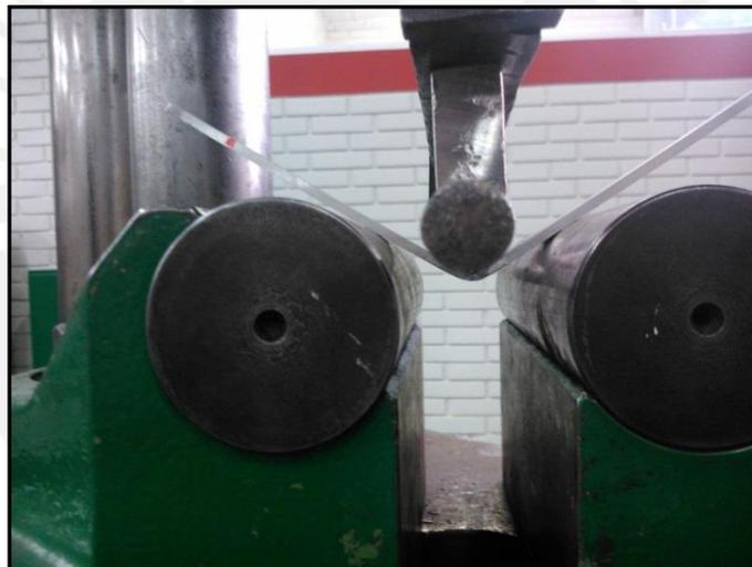
**Figura 2.23.** Ensayo de doblado a cupones soldados a tope.
