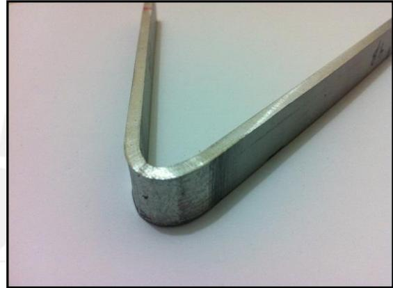
**Figura 3.13.** Doblado de cara en la probeta del cupón N°3.
