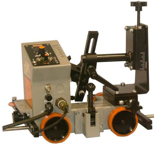
Figura 2.3. *Welding car* modelo MAGNETIC MOGGY.
