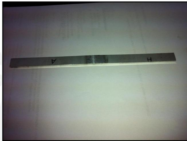
**Figura 2.20.** Probeta para ensayo de tracción de un cupón soldado a tope.
