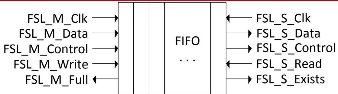
Figura 4.3: Diagrama de Bloques del Fast Simplex Link [33]
