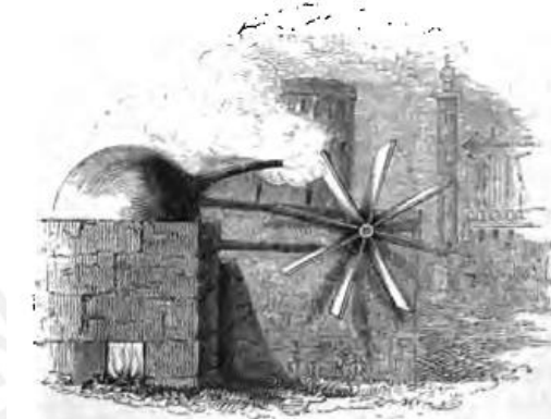
Ilustración 2. Turbina de impulso a vapor de Giovanni Branca (1629) (Fuente: The Steam Engine Explained and Illustrated. Dionysius Lardner, 1840)
