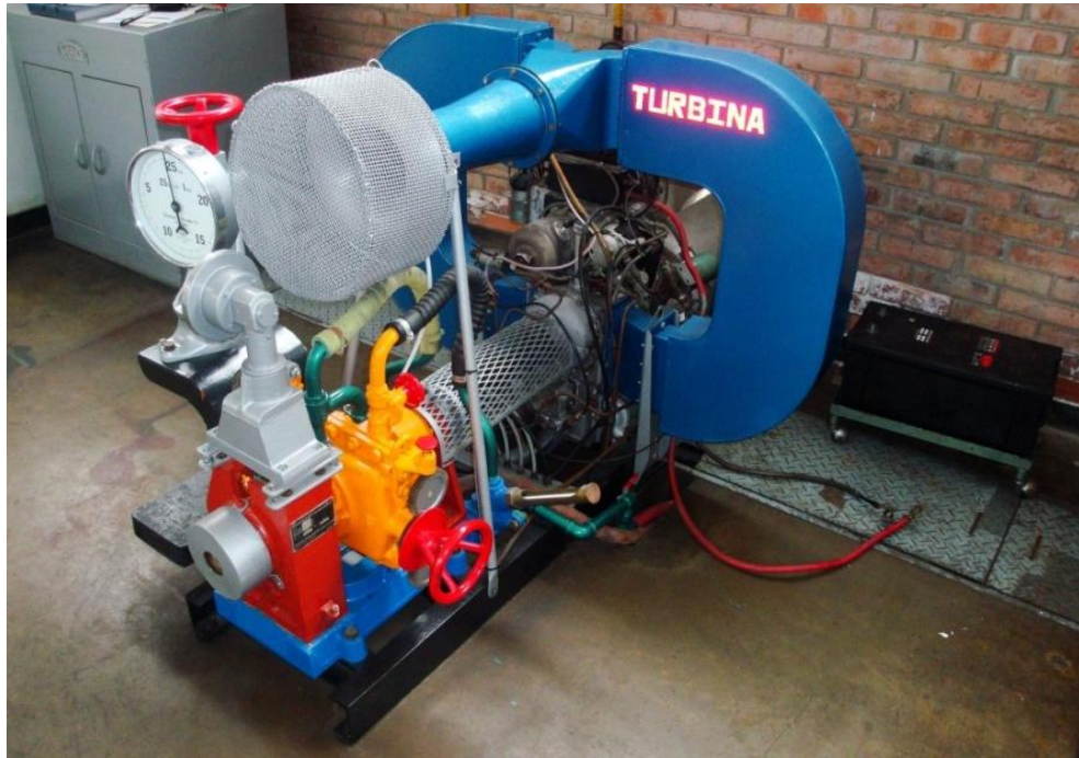
Ilustración 24. Fotografía de la turbina Rover, modelo IS/60 (Fuente: Propia )
