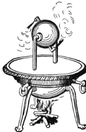
Ilustración 1. Eolípila de Herón de Alejandría (130 A.C.) (Fuente: Knight's American Mechanical Dictionary. 1876)
