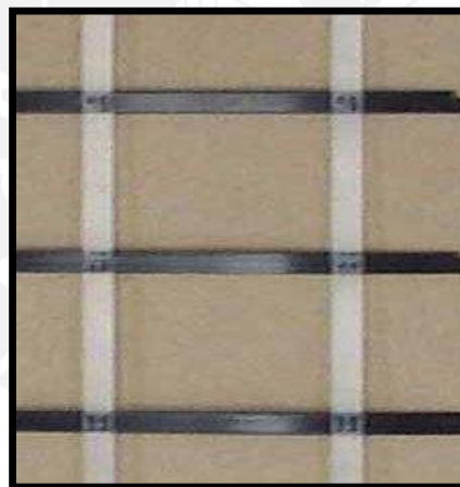
Figura 06. Geomalla uniaxial de polietileno soldada (Valencia, 2009)
