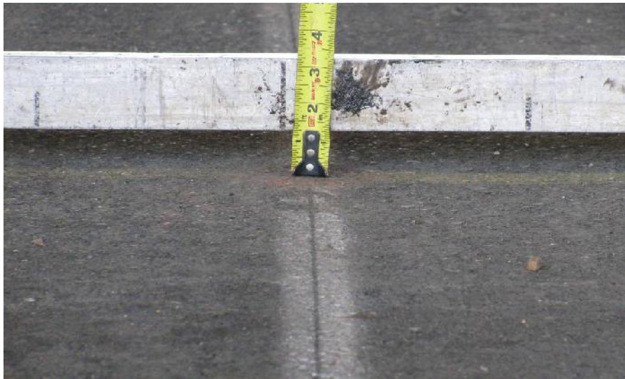
Figura 28. Medición del ahuellamiento (TENSAR, 2009)
