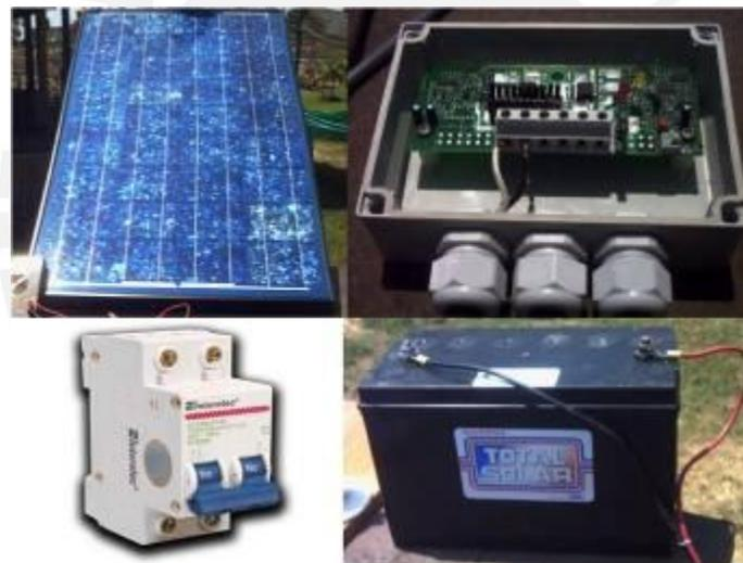
FIGURA 3-17: ELEMENTOS DELS SISTEMA DE ENERGÍA
