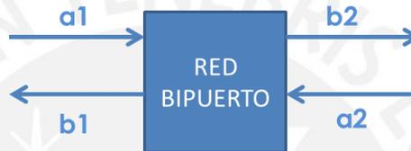
**FIGURA 2.3** Diagrama de red de dos puertos
