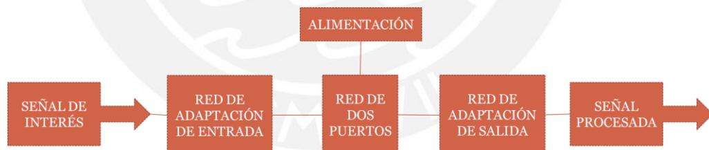
**FIGURA 2.6** Esquema de red de adaptación
