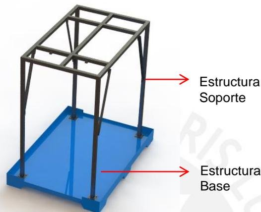
**Figura 2.12** Representación de la estructura soporte y base
