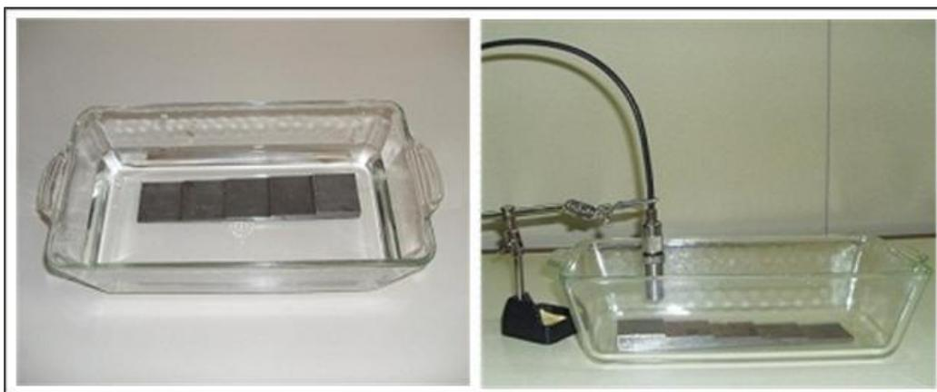
**Figura 32.** Pieza de prueba y posición del transductor en el envase de pruebas.
