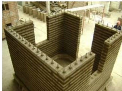
Fig.6.20. Construcción de la mitad superior del módulo.
