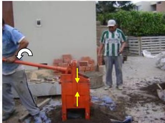
Fig.3.4 Proceso de fabricación de bloque.
