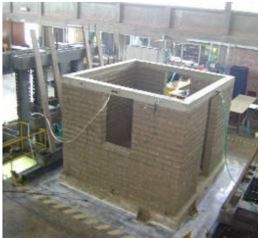
Fig.8.3. Instrumentación del módulo en el ensayo sísmico.
