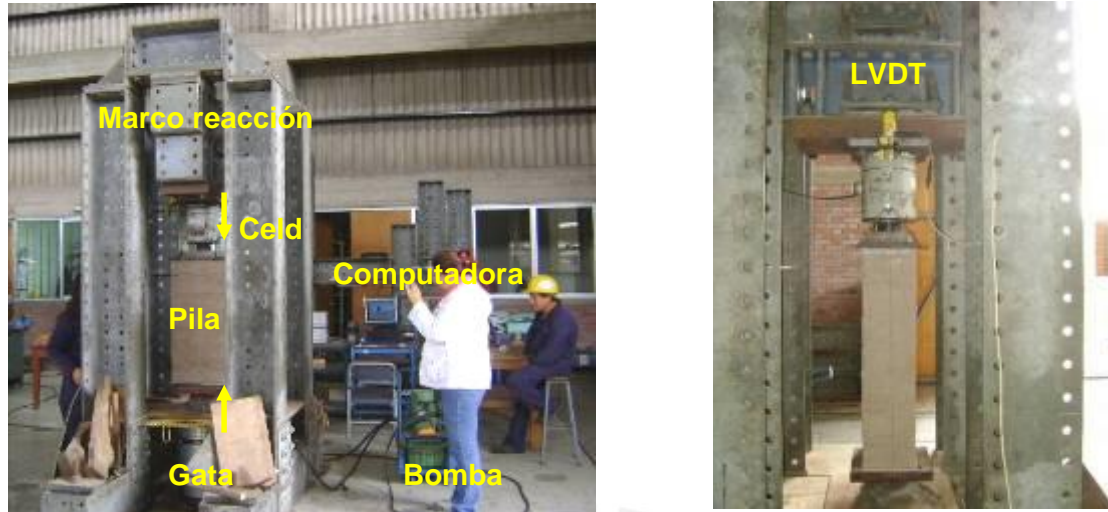
Fig.7.2. Dispositivos utilizados en el ensayo de las pilas a compresión.
