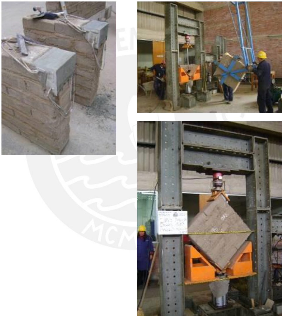
Fig.7.5 Capping en los muretes, transporte con puente grúa y dispositivos empleados en el ensayo de compresión diagonal.
