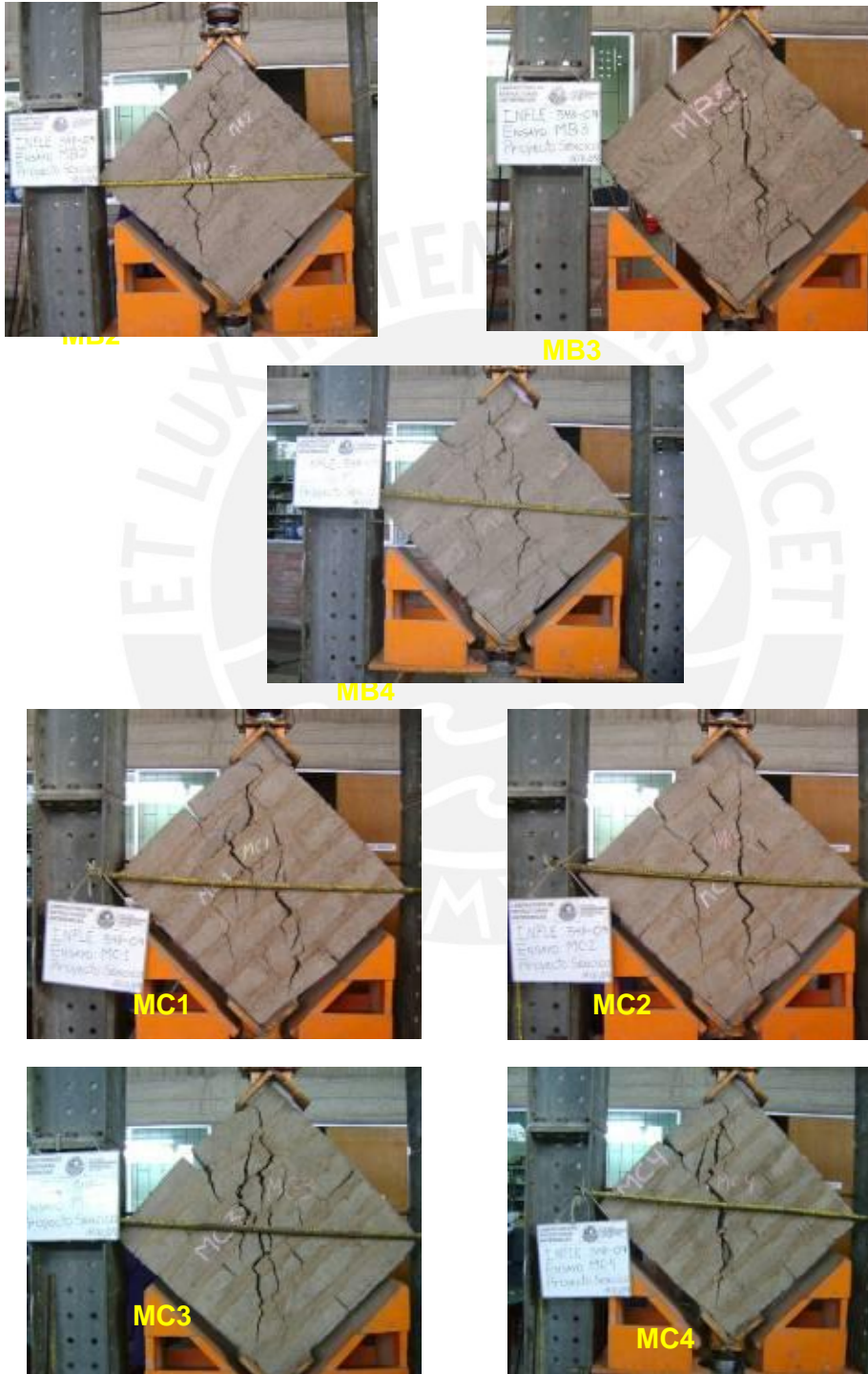
Fig.7.6 Forma de falla de los muretes hechos con mortero de barro (MB) y de los construidos con mortero barro-cemento (MC).
