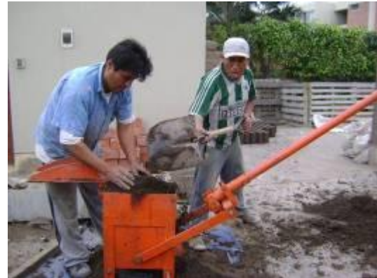
Fig.3.3 Depósito de mezcla en molde
