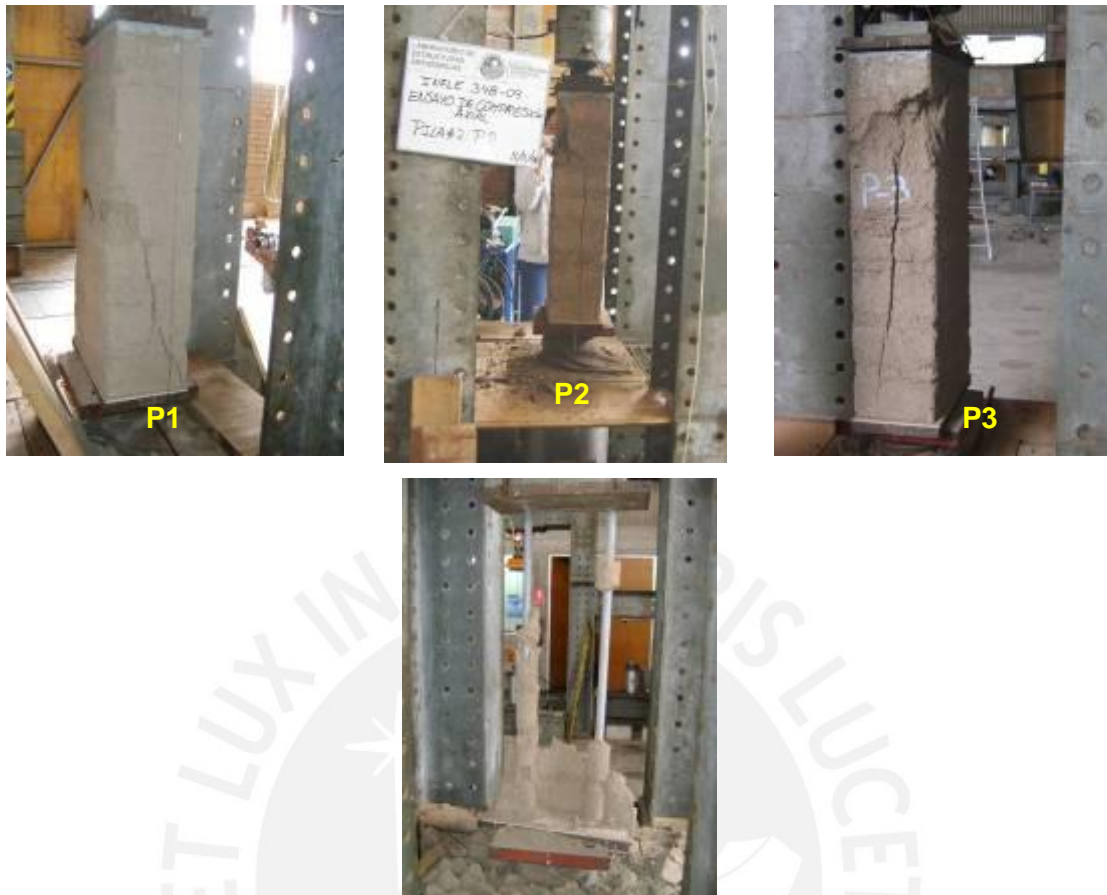
Fig.7.3 Forma de falla de las 3 pilas. Abajo se nota como parte del mortero de relleno quedó adherido al tubo PVC.
