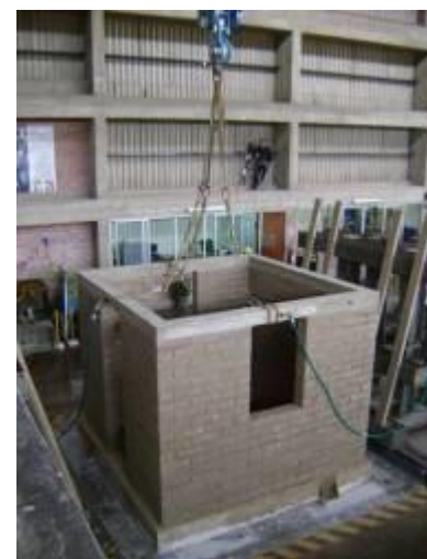
Fig.8.5. Fajas colocadas después de la Fase 1.
