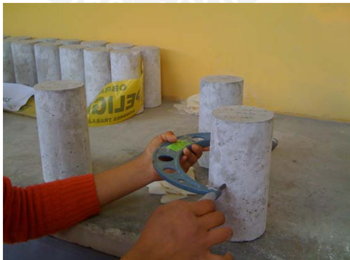
Imagen 5.09: Medición del diámetro de las probetas con el micrómetro
