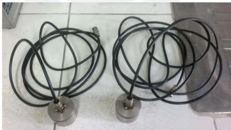
Imagen 4.03: Cables de conexión con sus transductores (emisor y receptor)
