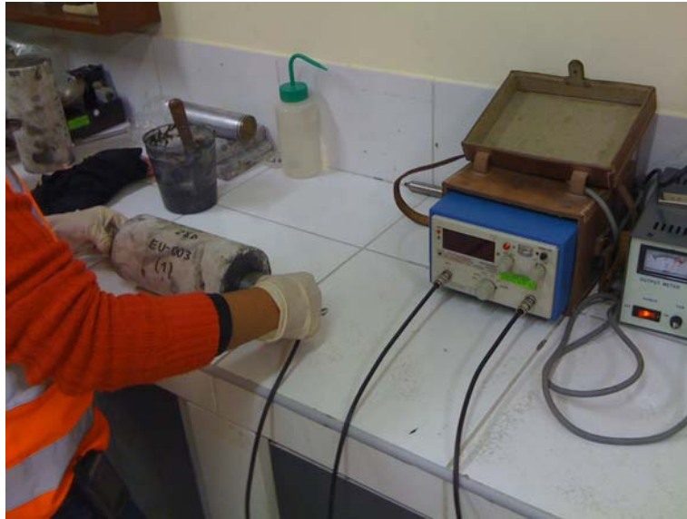
Imagen 5.08: Medición del tiempo de propagación del pulso ultrasónico
