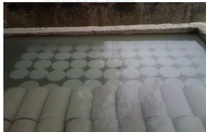
Imagen 5.14: Almacenaje en poza de agua con cal para curado de probetas tamaño 6"x12" a 28 días
