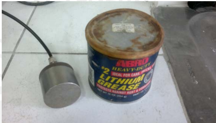
Imagen 4.05: Grasa útil para acoplar superficies de contacto con transductores
