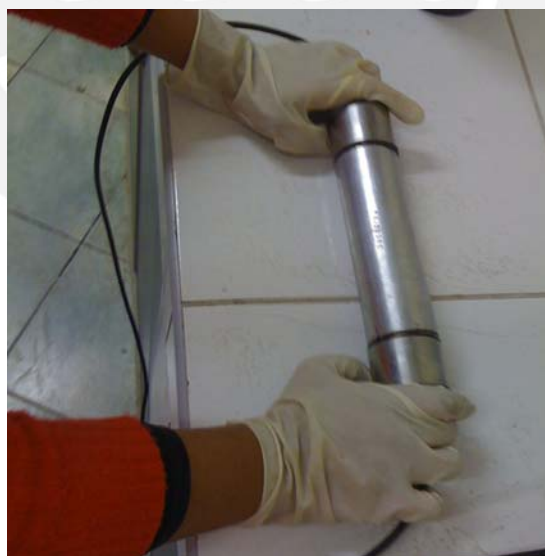
Imagen 5.07: Calibración del tiempo de propagación en base a referencia grabada en la barra calibradora
