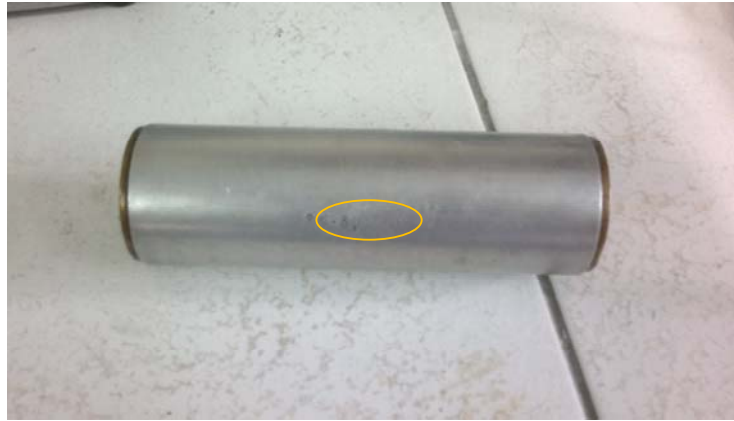
Imagen 4.04: Barra calibradora con tiempo de tránsito, de referencia, inscrito
