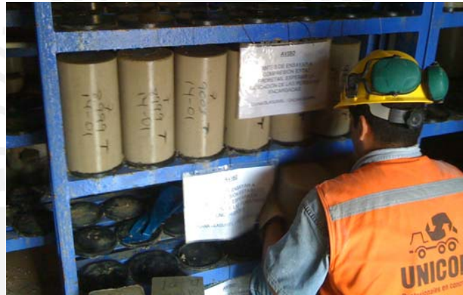
Imagen 5.14: Almacenaje en cámara de curado por aspersión para probetas tamaño 6"x12" a 7 días
