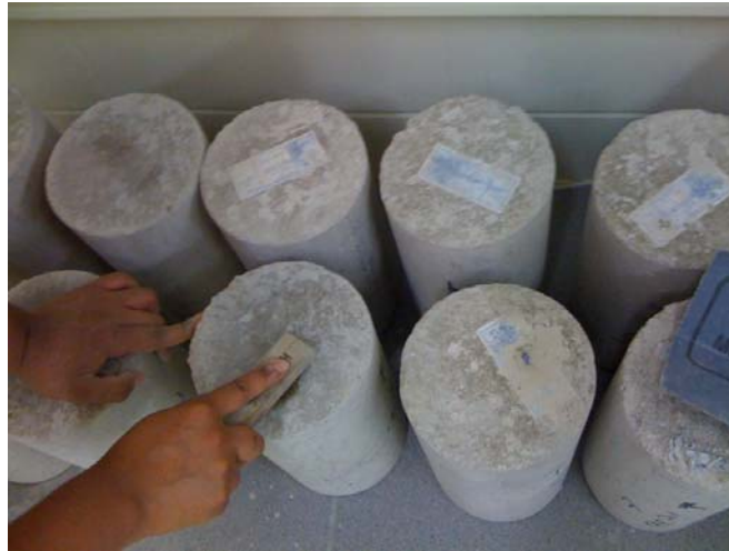
Imagen 5.04: Limpieza de las superficies de contacto en la probeta
