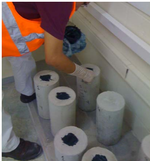
Imagen 5.06: Aplicación de grasa acoplante en los extremo de las probetas
