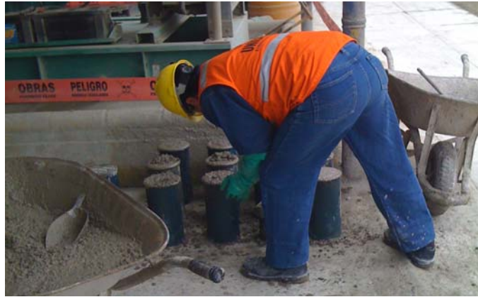
Imagen 5.13: Control en estado fresco y elaboración de probetas 6"x12"
