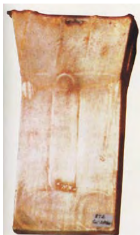
Fig. 27. Lingote de bronce estañífero con 5% de estaño. Nótese el color dorado (Hosler, 1997).
