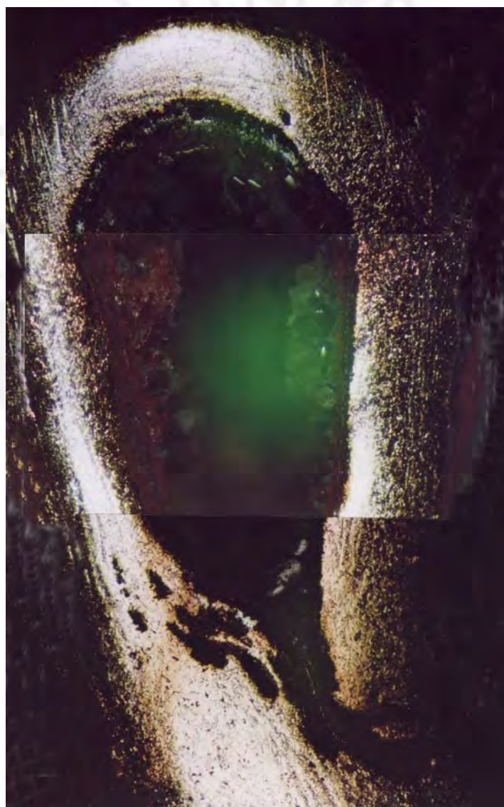
Fig. 41. Microscopia óptica: Evidencia de cómo se elaboró el ojal. 50x.
