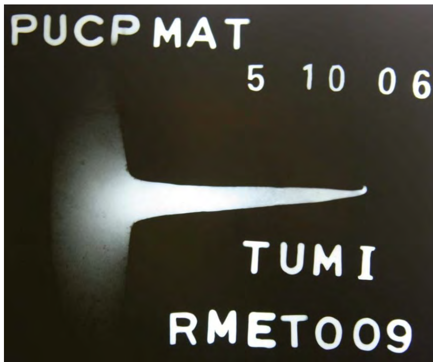
Fig. 39. Radiografía: Evidencia de corrosión (100 kV x 70 segundos).
