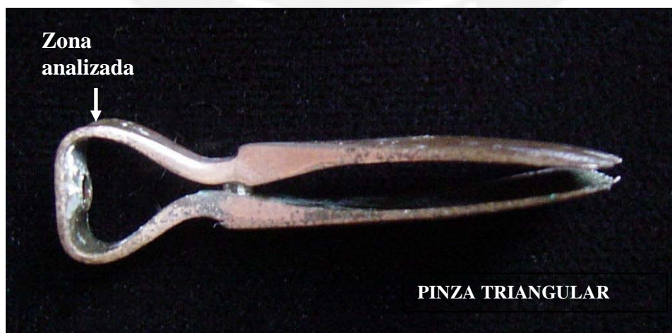
Fig. 23. Zona analizada de la pinza triangular.
