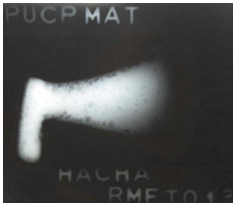
Fig. 20. Radiografía: Evidencia de porosidad interna (Fundición) (225 kV x 1 minuto).
