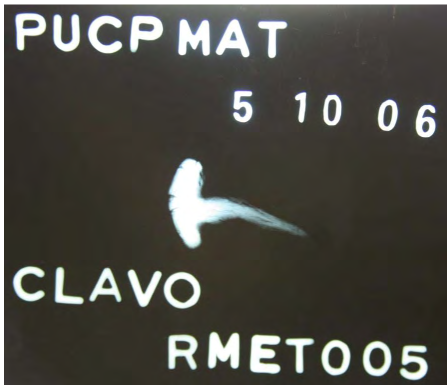
Fig. 65. Radiografía: Evidencia de la corrosión (100 kV x 1,5 minutos).
