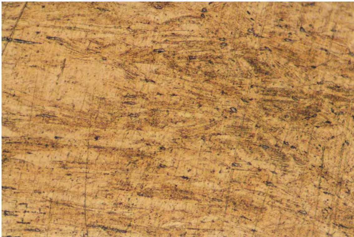
Fig. 60. Microscopia óptica de la cabeza: Solución sólida de Cu. Evidencia de líneas de deslizamiento. Granos alargados en el sentido de la deformación. Inclusiones no metálicas que indican la dirección en que se deformó plásticamente la pieza. 100x.
