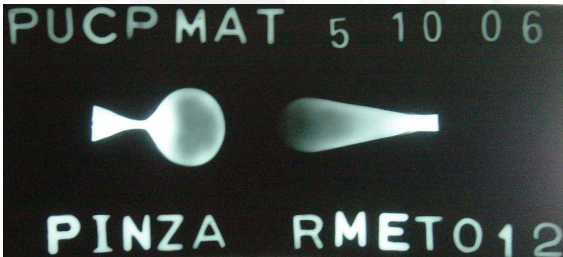
Fig. 33. Radiografía de las pinzas redonda y lágrima: No se evidencia ningún tipo de uniones (150 kV x 1 minuto).
