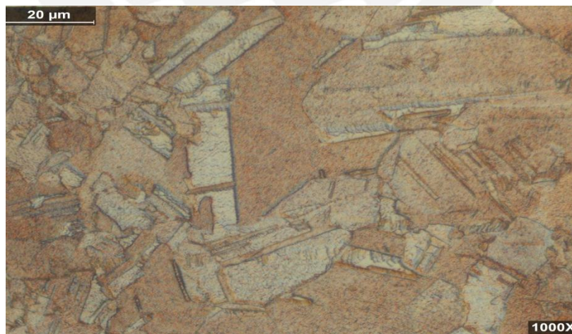
Figura 3.12. Microestructura del cobre empleado a 1000 aumentos
