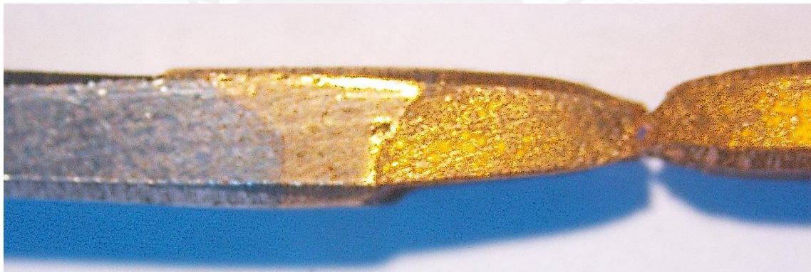
Figura 3.2. Probeta del cupón 3 sometida a tracción. Aumento de 6.5.
