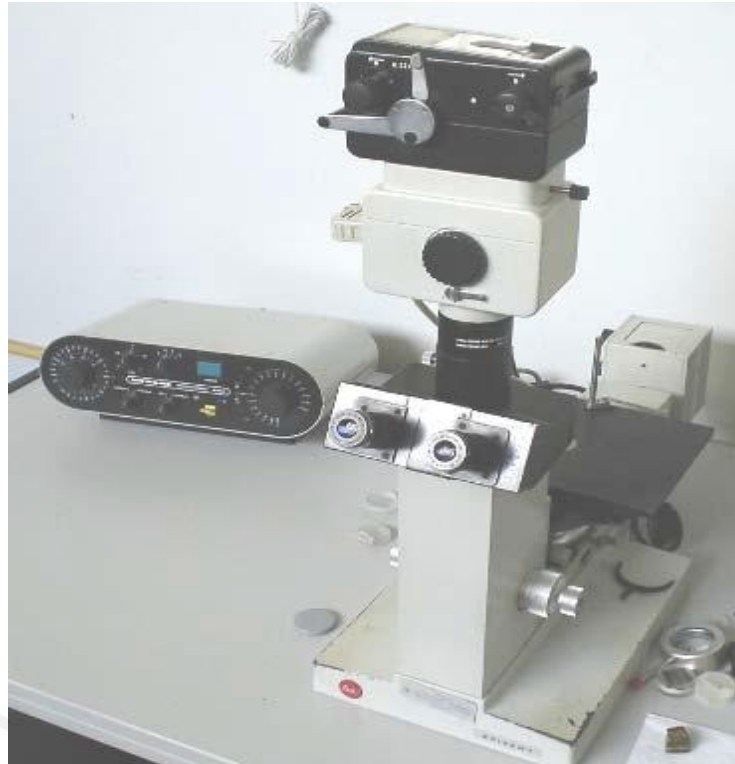
Figura 2.9. Microscopio con cámara Leiz para la caracterización microestructural.
