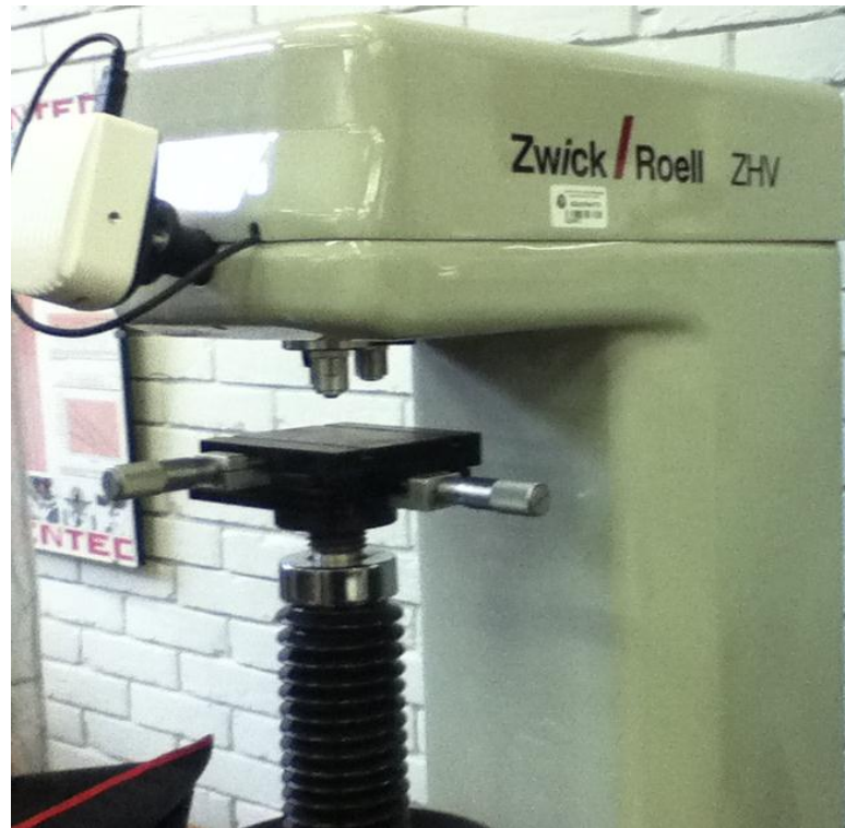
Figura 2.6. Equipo para microdureza Vickers Zwick/Roell ZHV
