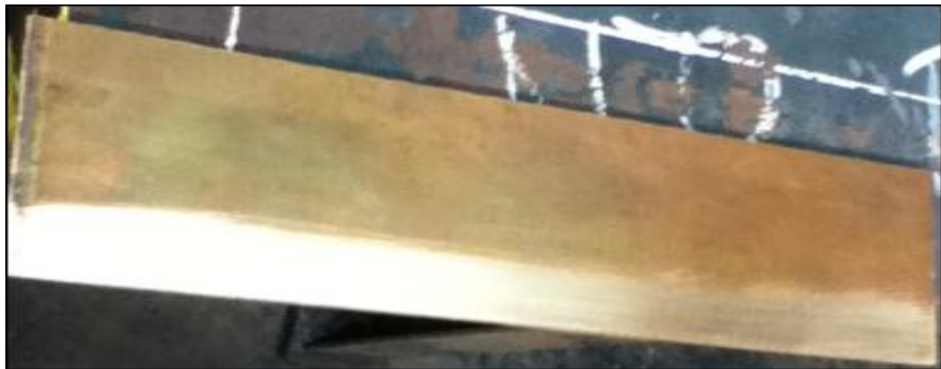
Figura 2.4. Plancha de cobre a ser soldada donde se aprecia la limpieza de borde realizada
