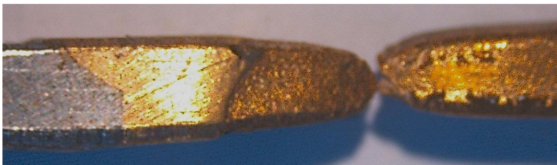
Figura 3.3. Probeta del cupón 3 traccionada. Aumento de 6.5.
