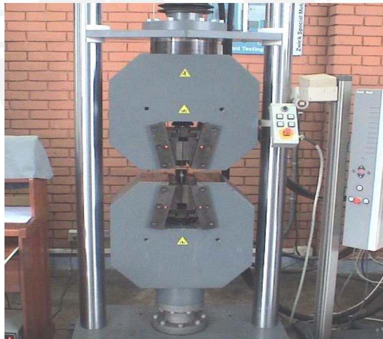
Figura 2.5 Máquina de tracción Zwick Roell Special Metal Testing Machina SP
