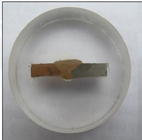
Figura 2.7. Probeta para el ensayo de microdureza
