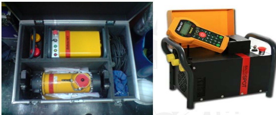
Figura 4.13. Tubo, unidad de control, cables y control remoto
