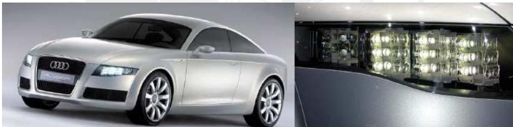
**Figura 2.7** Utilización de LEDs de potencia en Audi Nuvolari [37]
