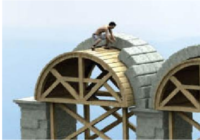
Figura N° 3.1: Técnica de dovelas yuxtapuestas.
