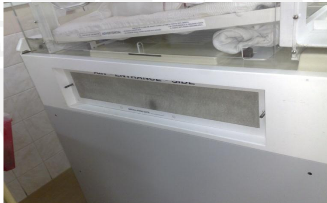
Figura 09. Filtro de aire incubadora # 02 - UCIN INT del INMP, 2011.
