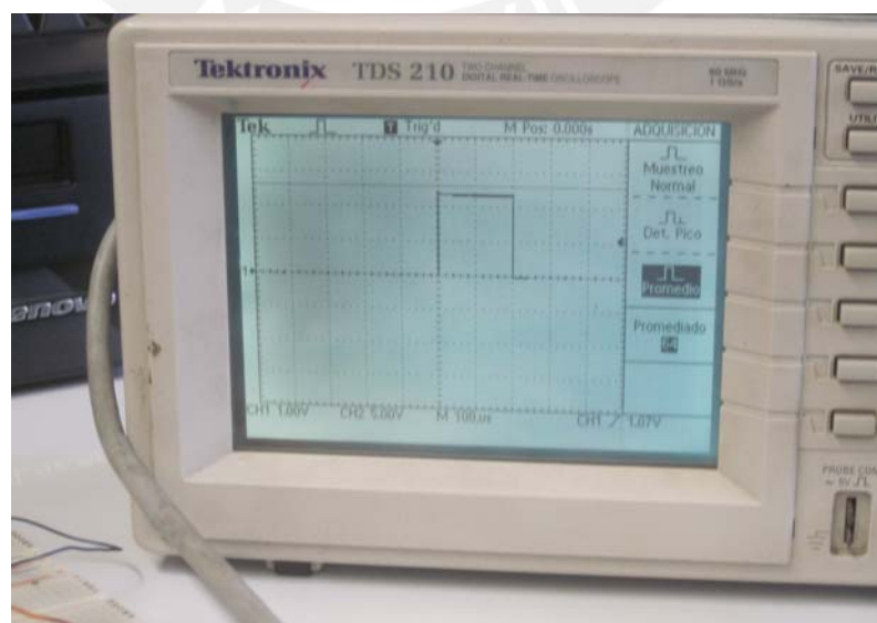
Figura 4.9: Pulso Cuadrado de 2.5 V DC de amplitud y 200 \mu seg de duración.
