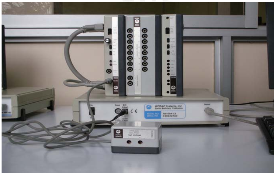
Figura 3.3: Sistema de adquisición de datos MP100 y sus dispositivos.
