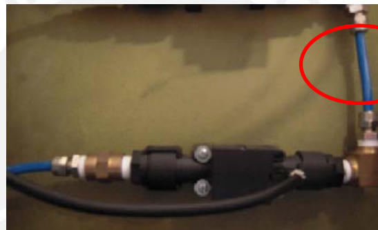
Figura 2-5: Conexión de los sensores de flujo al sistema neumático
