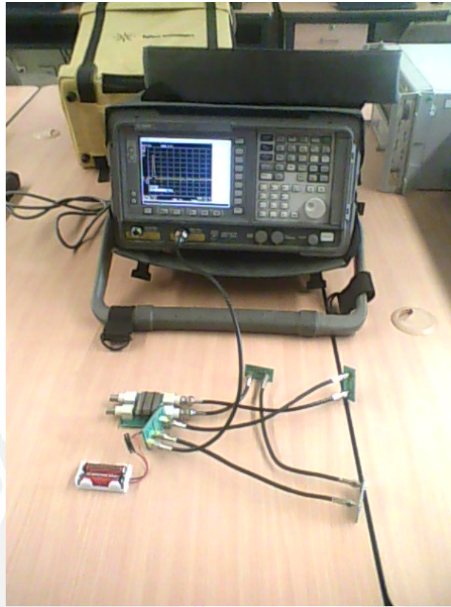
Figura 4.9: Lazo oscilador conectado al analizador de espectros
