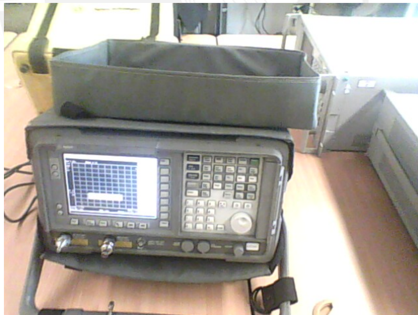
Figura 4.6: Analizador de espectros Agilent E4401
