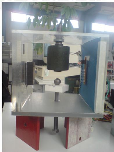
Figura 4.1: Módulo de levitación magnética de una esfera metálica
