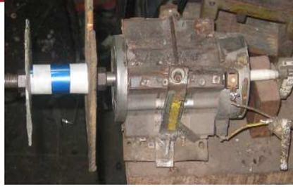
Figura 3.3: Material aislante en el proceso de fabricación del electroimán
