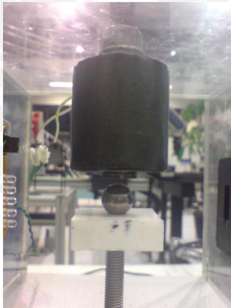
Figura 4.17: Prueba en laboratorio del módulo de levitación magnética sin sistema de control
