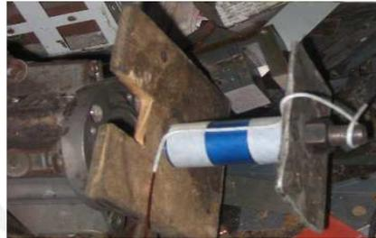
Figura 3.4: Inicio del devanado en el proceso de fabricación del electroimán
