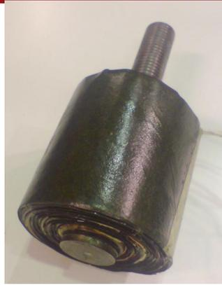
Figura 3.6: Acabado final del proceso de fabricación del electroimán
