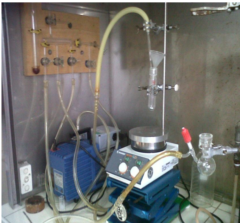
Figura 60: Sistema de reacción para las polimerizaciones. Laboratorio de Polímeros, Sección Física PUCP.
