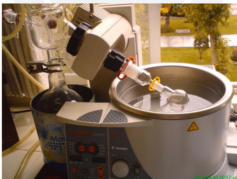
Figura 61: Equipo evaporador rotatorio utilizado para eliminar los solventes de las soluciones poliméricas. Laboratorio de Polímeros, Sección Física PUCP.
