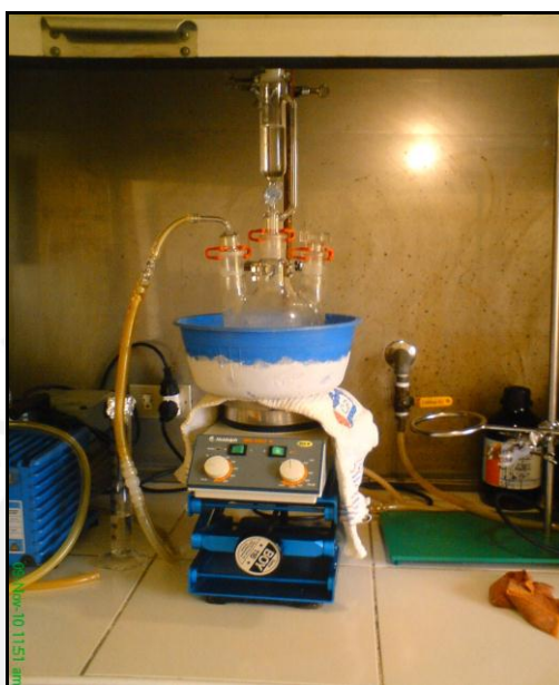
Figura 58: Sistema de reacción utilizado para la síntesis del monómero 2-carboxietil-2-oxazolona (ESTEROXA). Laboratorio de Polímeros (Dr. Juan Rueda), Sección Física PUCP.
