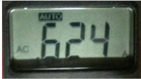
Figura 6.5. Valor de la corriente medida en una pinza amperimétrica.
