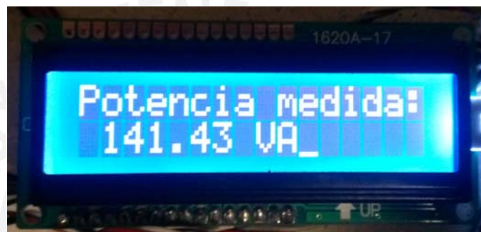
Figura 6.6. Valor de la potencia hallada a través del sensor de corriente
