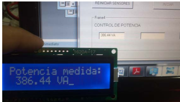
Figura 6.7. Visualización del valor de la potencia medida en el LCD y en la interfaz del computador.
