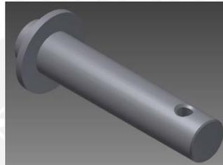
Figura 3.18: Pasador que se utiliza en la parte media de los brazos de elevación
