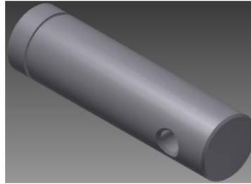
Figura 3.17: Pasador que se utiliza entre las ruedas y brazos de elevación
