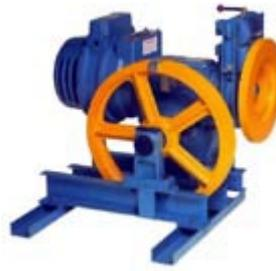
Figura 1.22: Motor acoplado a una polea de tracción
