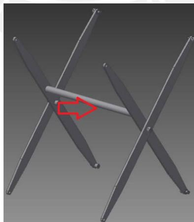
Figura 3.19: Barra circular que une los brazos de elevación
