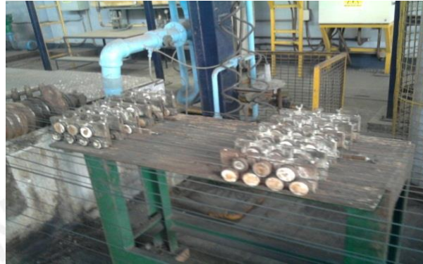
Figura 5.8: Rodillos tensionadores para disminuir la vibración del alambre Fuente: La empresa
