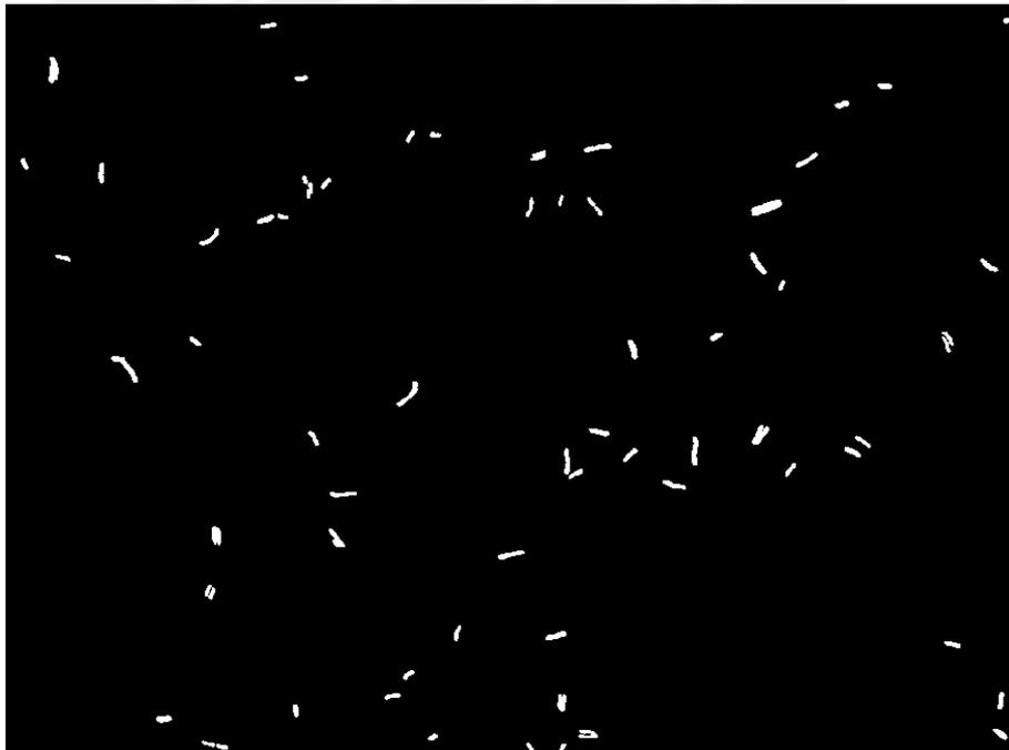
**Figura 3.3:** Imagen binaria obtenida de la segmentación manual de la imagen de la Figura 3.1 con ayuda del software libre *ImageJ*. En el Anexo A se
