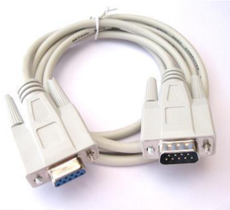
Fig. 9: Cable para estándar RS-232 DB9 (Tomado de www.kellycontroller.com )
