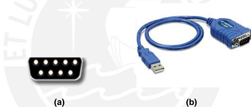
Fig. 12: (a) Puerto RS-232 DB9 (b) Cable adaptador RS-232/USB de TrendNet (Tomado de trendnet.com)
