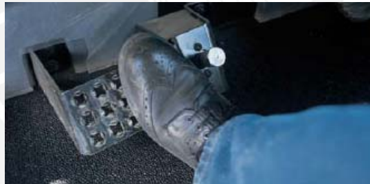
Figura 2.7. Traba de diferencial interaxial del camión Caterpillar 740.
