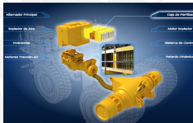
Figura 1.10. Componentes y transmisión del camión minero Komatsu.
