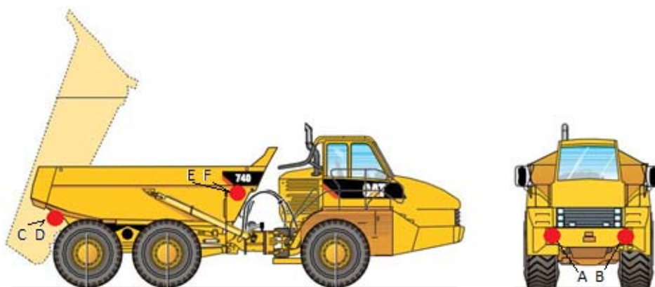
Figura 3.58. Ubicación de los sensores de ultrasonido en el camión minero 740.
