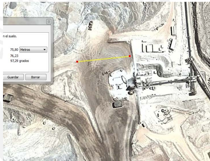
Figura 3.17. Espacio de parqueo en las Chancadoras de la mina SMCV (76 metros).
