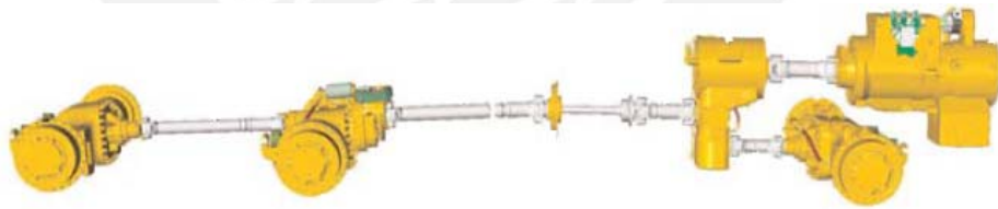
Figura 2.3. Transmisión mecánica con transferencia de datos electrónicos del camión Caterpillar 740.
