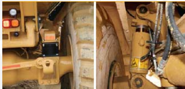
Figura 2.5. Suspensión delantera del camión Caterpillar 740.
