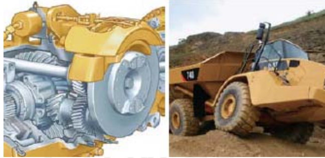
Figura 2.6. Control de tracción del camión Caterpillar 740.
