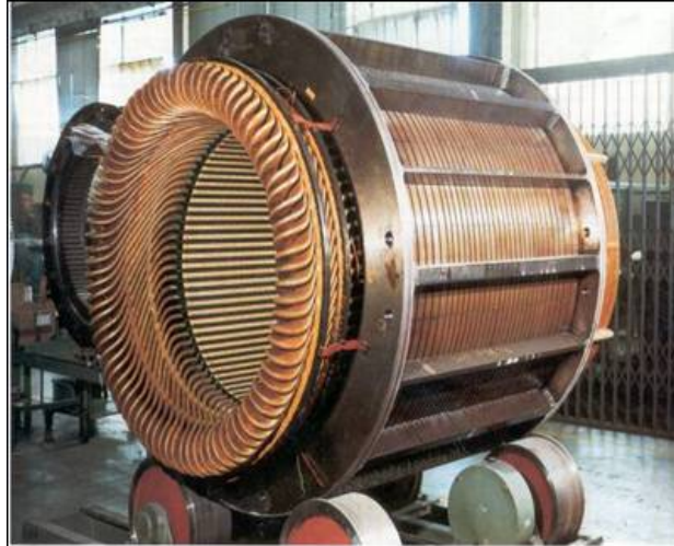
Figura 1.3 Armadura o inducido de un generador síncrono en el estator (Fuente: http://www.monografias.com/trabajos82/generadores-sincronos/generadores-sincronos2.shtml#partesdeua )
