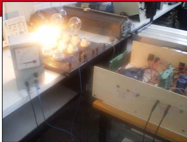
Figura 4.6 Prueba con bombilla 2 – fuente para el campo del motor (Fuente: Propia)
