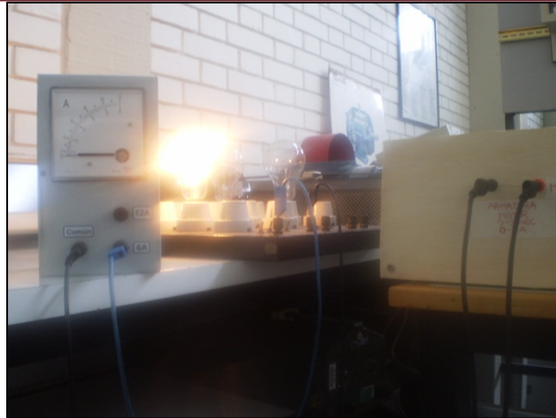
Figura 4.9 Prueba con bombilla 3 – fuente para la armadura del motor (Fuente: Propia)
