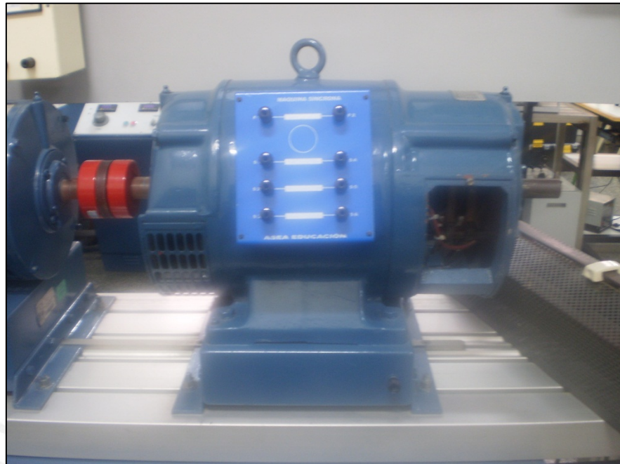
Figura 1.1 Generador síncrono trifásico del Laboratorio de Máquinas Eléctricas de la PUCP (Fuente: Propia)
