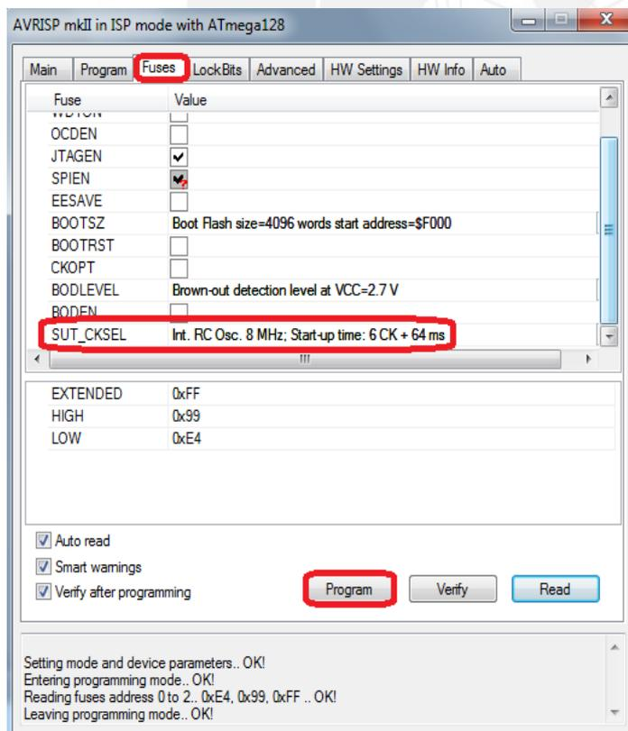
4. En la misma pestaña, Fuses, se debe seleccionar la frecuencia de trabajo del microcontrolador entre las distintas opciones que se presentan en la lista despegable del fusible SUT\_CKSEL y hacer nuevamente click en Program para que realice el cambio respectivo.
