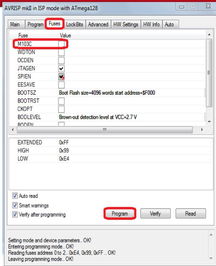
3. En la pestaña Fuses se debe tener mucho cuidado con el fusible **M103C**, el cual viene activado por defecto haciendo que el Atmega128 adopte todas las características del Atmega103 y no funcione como debería hacerlo. Por lo tanto, se debe desactivar este fusible y hacer click en Program para concretar el cambio realizado.
