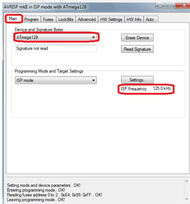
2. En la pestaña Main se elige el microcontrolador a programar en la opción Device and Signature Bytes. La opción Programming Mode and Target Settings por defecto estará en ISP mode y en Settings se elige la frecuencia de programación que debe ser como máximo la cuarta parte de la frecuencia de trabajo del microcontrolador.
